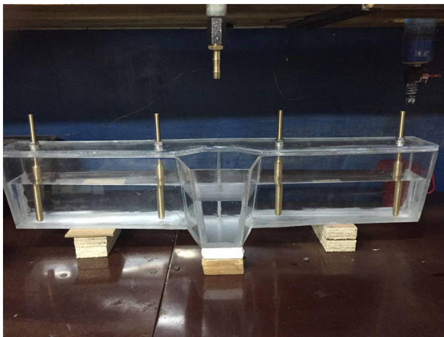
Рис. 8. Модель Т-образного промежуточного ковша в масштабе 1:10
