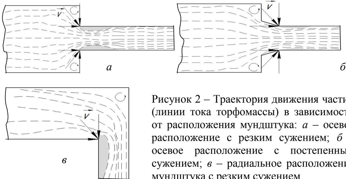
Рисунок 2 – Траектория движения частиц (линии тока торфомассы) в зависимости от расположения мундштука: *a* – осевое расположение с резким сужением; *б* – осевое расположение с постепенным сужением; *в* – радиальное расположение мундштука с резким сужением
