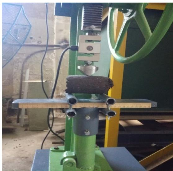
Рисунок 11 – Испытание на изгибную прочность образцов кускового торфа круглого сечения
