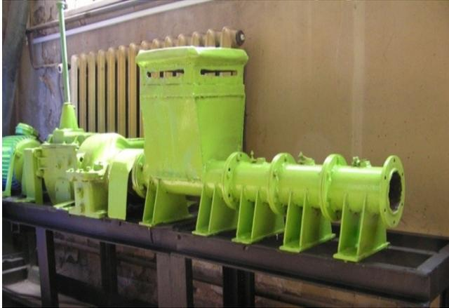
Рисунок 3 –Лабораторный шнековый пресс Рисунок 4 – Формование торфа
