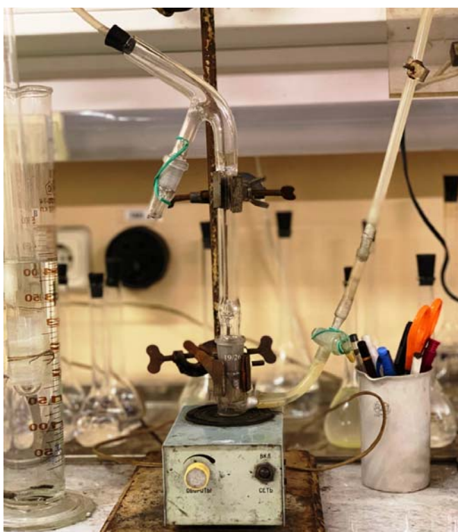
Рисунок 14 – Трубка Халлимонта для беспенной флотации
