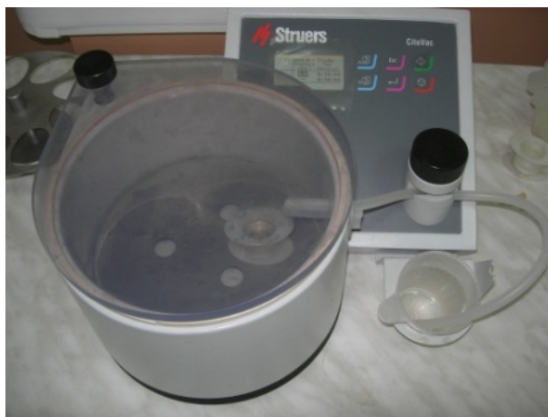
Рисунок 5 – Импрегнатор для холодной запрессовки проб CitoVac фирмы «Struers»
