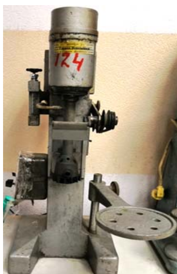
Рисунок 21 – Лабораторные флотомашинки объемом камеры 0,075 л (а), 0,5 л (б), 3 л (в)
