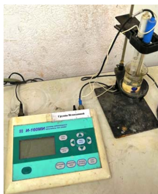
Рисунок 16 – Иономеры: а – pH (И160МИ), б – Eh (И-160М)
