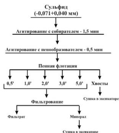
Рисунок 22 – Методика проведения пенной флотации мономинералов (а) и рудного материала (б)
