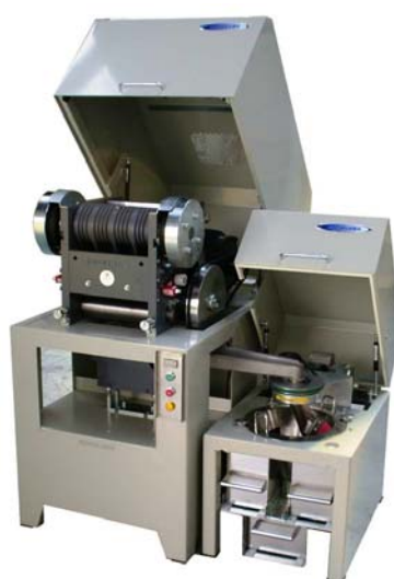
Рисунок 17 – Щековая дробилка БОЙД MARK III с делителем (RSD)
