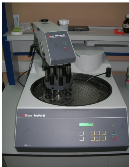
Рисунок 7 – Шлифовально-полировальный станок RotoPol 35 с держателем образцов PmdForce 20 фирмы «Struers»
