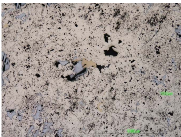
Рисунок 70 – Халькопирит в сростании с галенитом в матрице пирита (а) и в виде включений в матрице сфалерита (б). Изображение в отраженном свете
