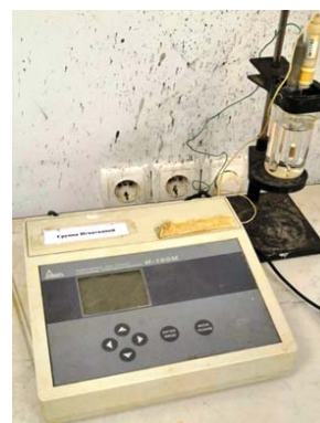
Рисунок 16 – Иономеры: а – pH (И160МИ), б – Eh (И-160М)
