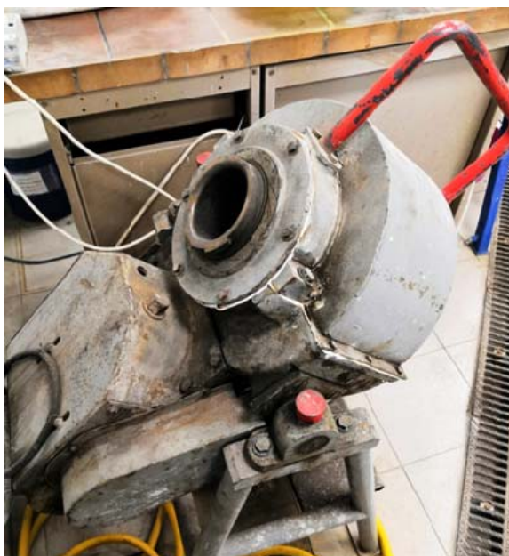
Рисунок 19 – Лабораторная шаровая мельница с объемом 7 л
