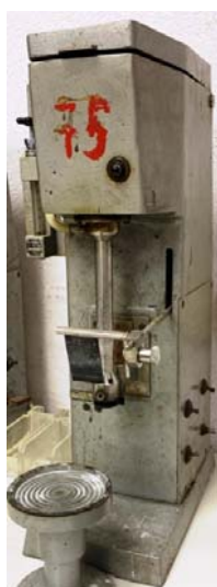
Рисунок 21 – Лабораторные флотомашинки объемом камеры 0,075 л (а), 0,5 л (б), 3 л (в)
