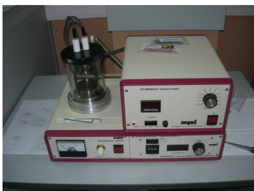
Рисунок 8 – Вакуумный напылитель углеродного слоя SPI
