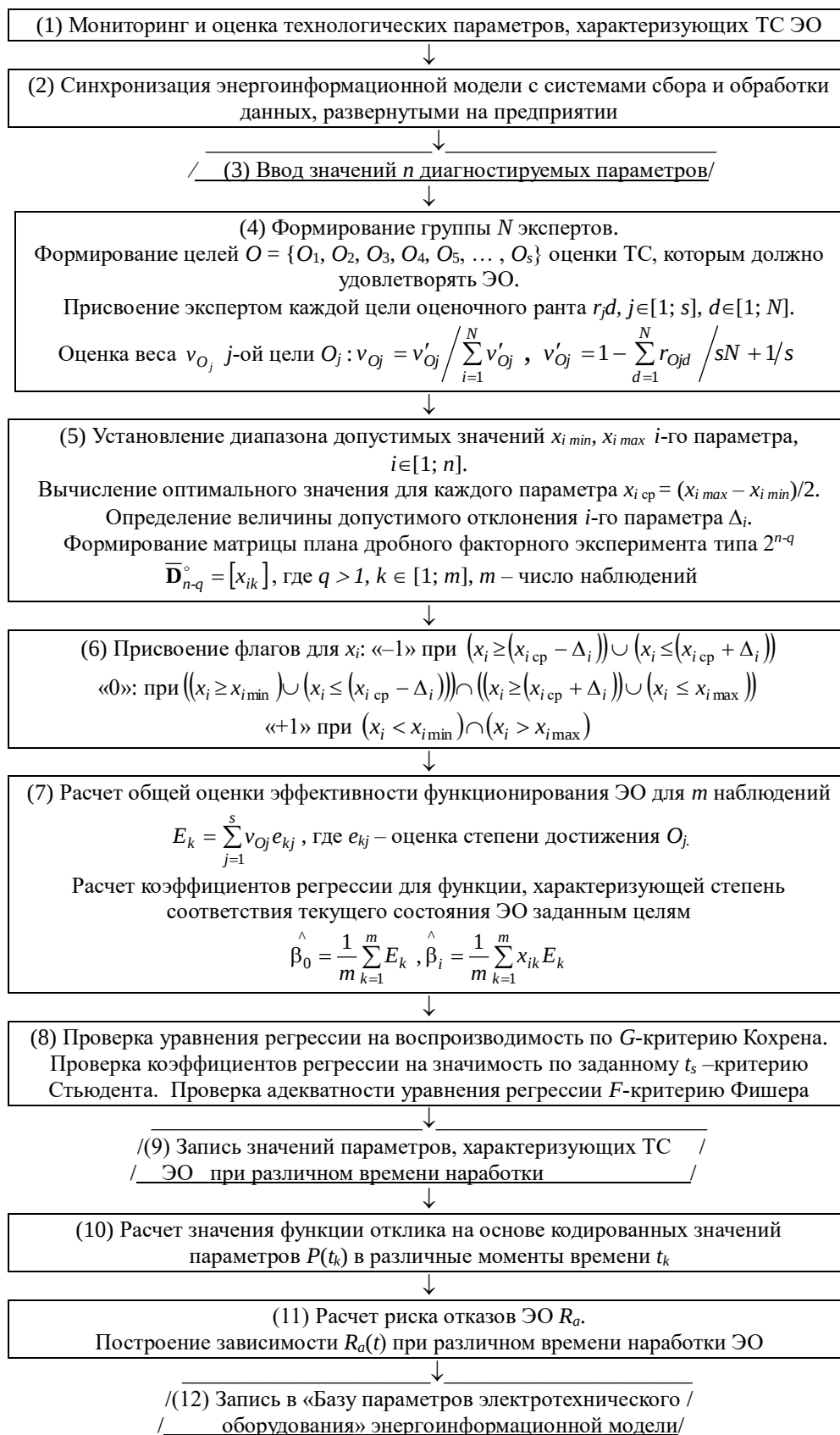
Рисунок 8 – Блок-схема комплексной оценки технического состояния электротехнического оборудования
