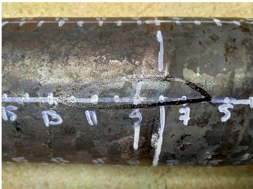
Рисунок 22 – Заторможенный образец в калибровочном стане ТПА 160
