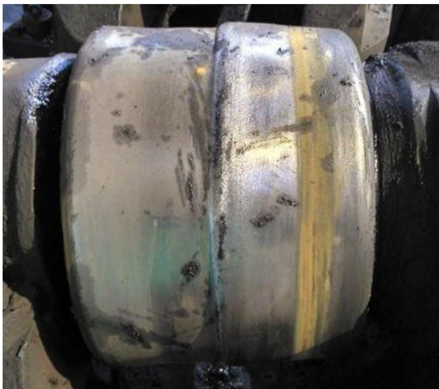
Рисунок 31 – Фотография валка раскатного стана с используемой калибровкой
