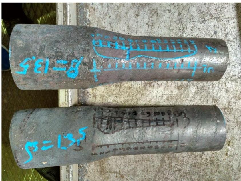
Рисунок 17 – Заторможенные гильзы полученные при безопрвоочной прокатке на стане МИСиС 130 Т
