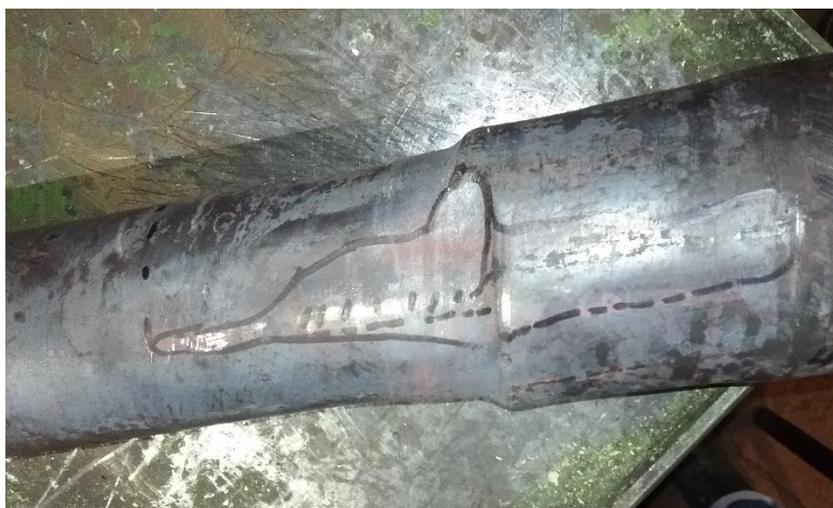
Рисунок 36 – Заторможенный образец, полученный при раскатке на оправке в раскатном стане ТПА 160
