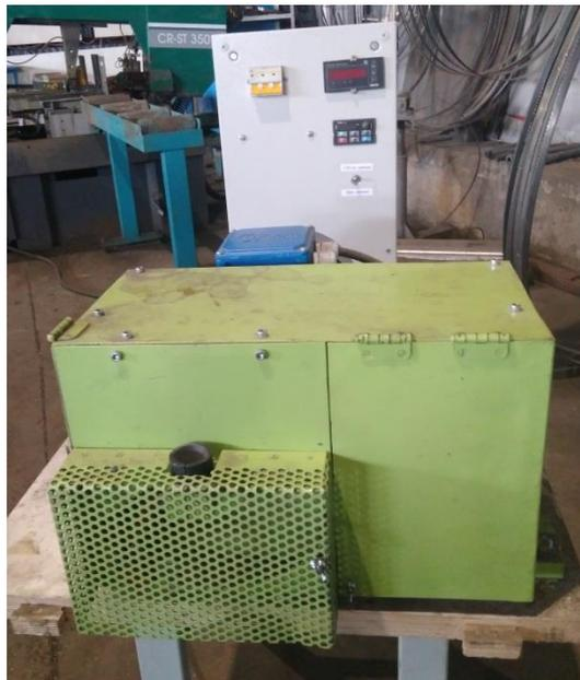
Рисунок 3.8 – Внешний вид испытательной машины с защитными кожухами
