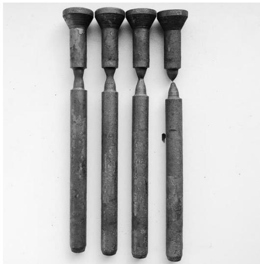
Рисунок 4.6 – Внешний вид образцов из стали 45 после эксперимента
