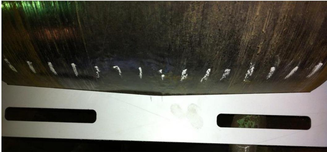
Рисунок 5.29 – Выработка исходного профиля рабочего валка стана винтовой прокатки МИСиС-130Д во входном конусе
