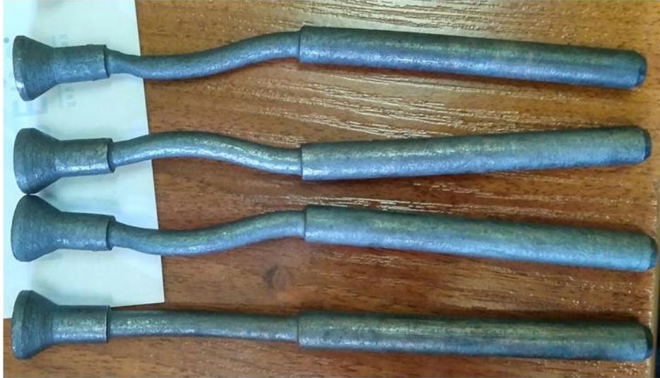
Рисунок 4.4 – Внешний вид образцов из стали 45 после испытаний
