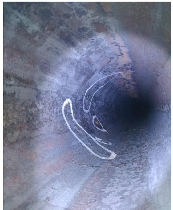
Рисунок 1.2 - Плена на внутренней поверхности трубы
