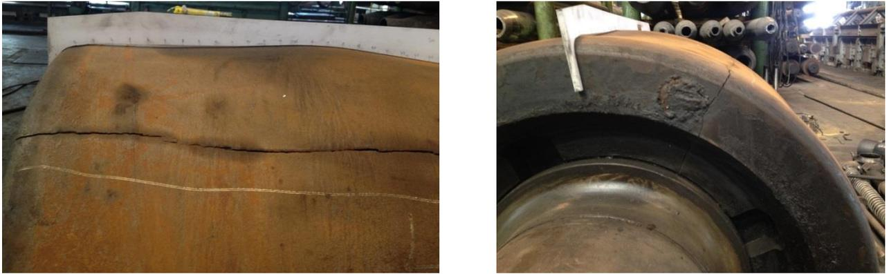
Рисунок 5.10 – Трещина бочки нижнего валка прошивного стана ТПА 159-426
