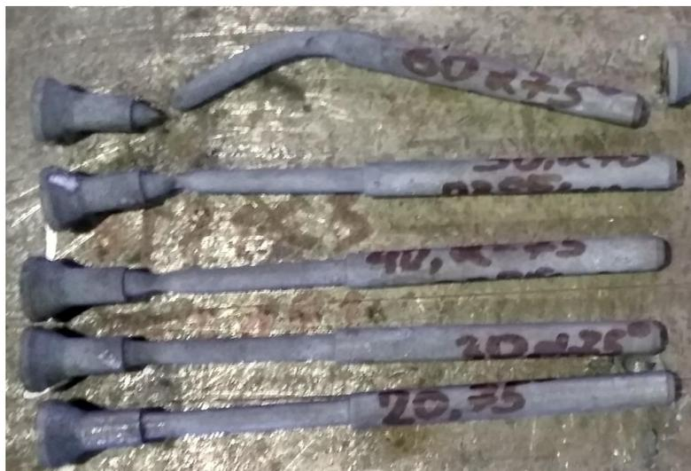
Рисунок 4.3 – Внешний вид образцов из стали 45 после испытаний
