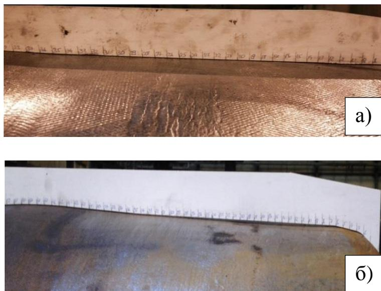
Рисунок 5.2 – Внешний вид входного конуса изношенных валков: а – нижний валок после прокатки 3205 тонн; б – верхний валок после прокатки 17364 тонн
