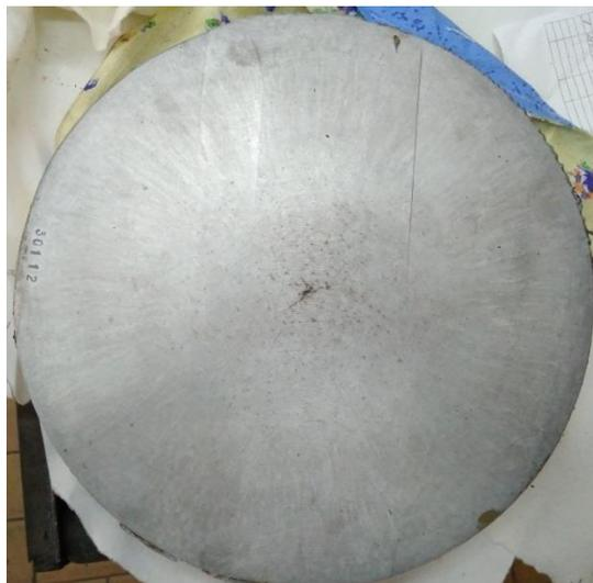
Рисунок 1.5 - Темплет НЛЗ Ø360 мм из стали марки 28X3CHM1ФА (СП-28)
