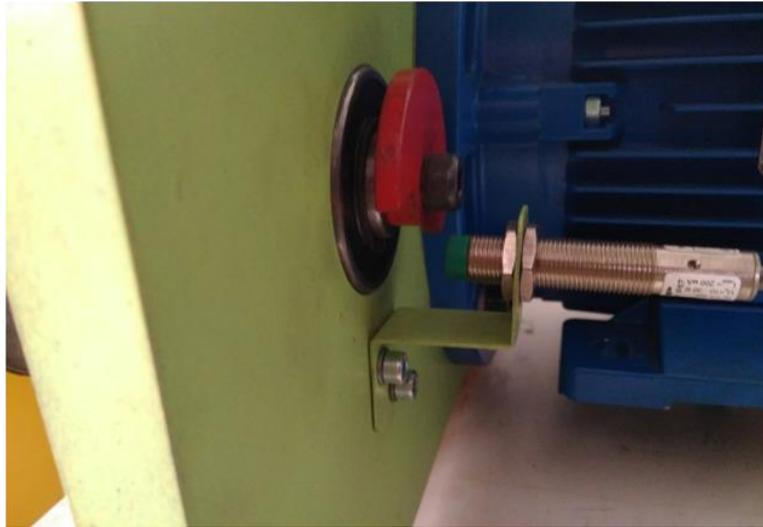
Рисунок 3.7 – Фигурная шайба с бесконтактным датчиком
