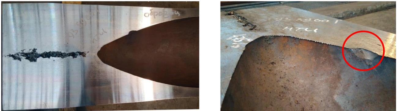
Рисунок 2.7 – Центральная пористость НЛЗ из стали марки 32ХГА Ø340 мм и дефект на внутренней поверхности гильзы
