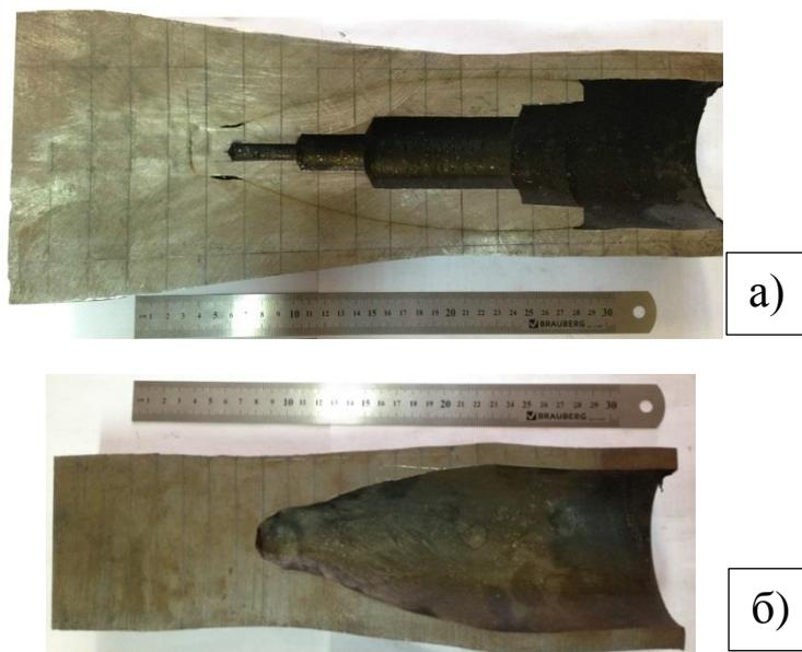
Рисунок 5.14 – Внешний вид заготовок-гильз, заторможенных в прошивном стане с использованием чашевидных (а) и бочковидных (б) валков
