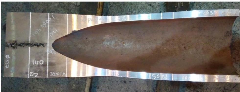
Рисунок 2.5 – Продольный темплет заторможенной заготовки-гильзы
