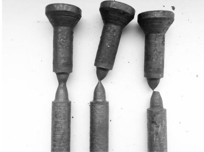
Рисунок 4.7 – Внешний вид образцов из стали 09Г2С после эксперимента
