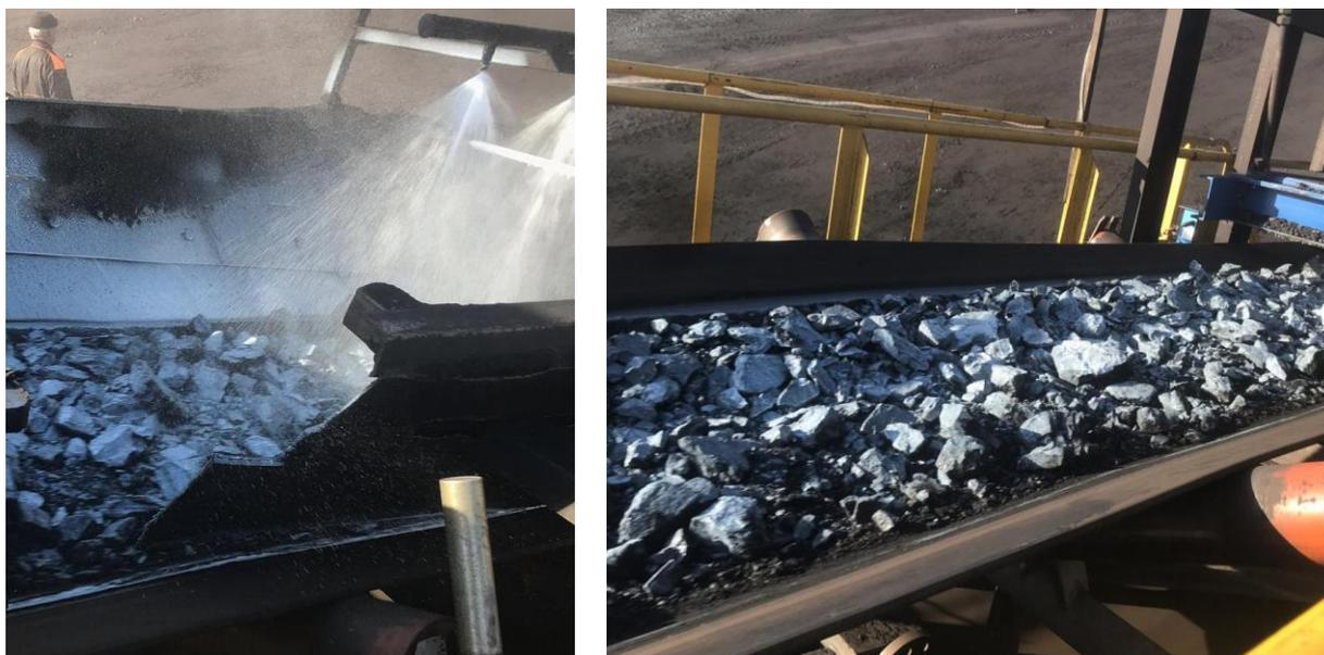
Рисунок 9 – Общий вид обработки угля раствором на конвейере
