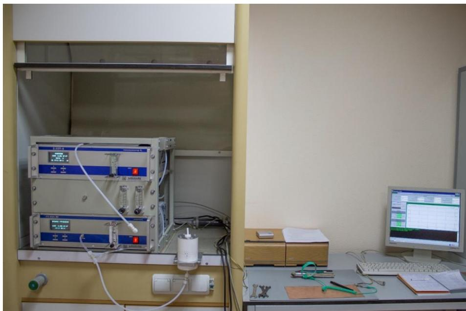
Рисунок 5 – Экспериментальная установка для обработки углей озоном
