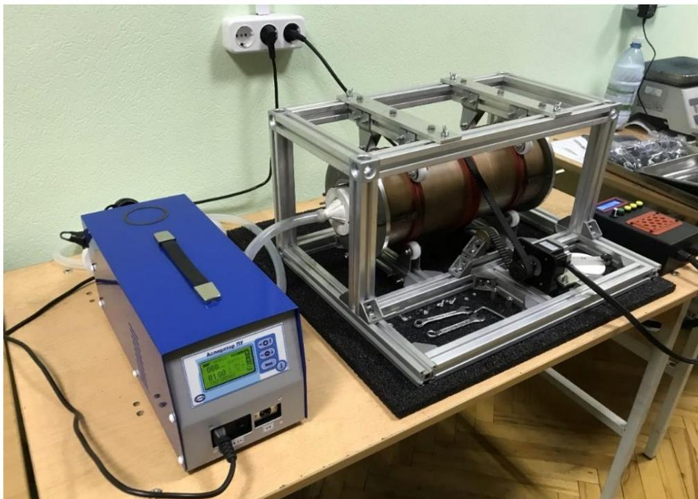
Рисунок 6 – Лабораторная установка для определения содержания пыли в углях
