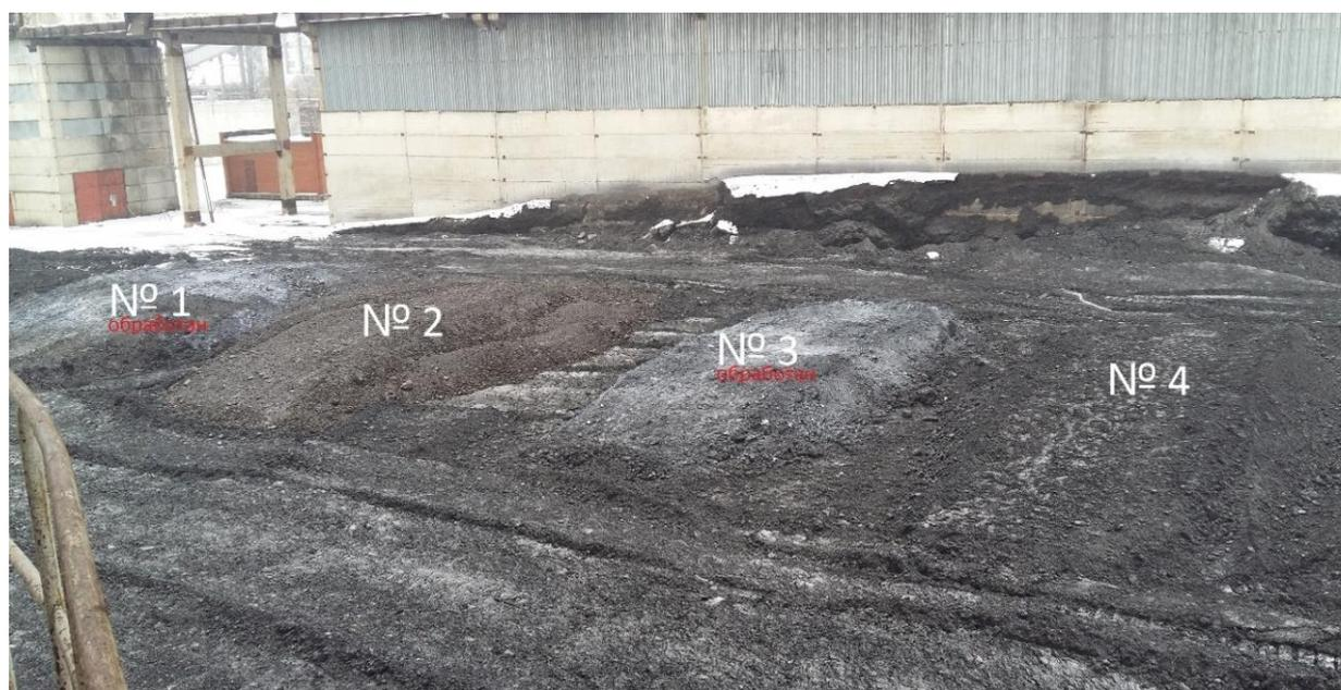
Рисунок 11 – Сравнение внешнего вида штабелей с обработкой и без
