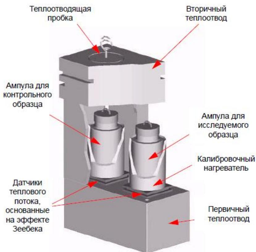
Рисунок 2 – Изотермический калориметр «ТАМ Air». Вид в разрезе: двойная конфигурация, один из восьми калориметрических каналов
