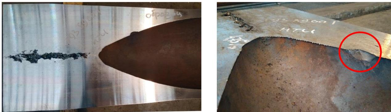
Рисунок 1 – Центральная пористость НЛЗ из стали марки 32ХГА Ø340 мм и дефект на внутренней поверхности гильзы
