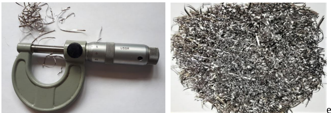
Рисунок 16 – Внешний вид лигатуры МФ7, полученной разными методами литья а) Внешний вид медно-фосфорных слитков диаметром (45 - 50) мм, полученных непрерывным литьём в графитовый кристаллизатор; б) Внешний вид медно-фосфорных прутков диаметром (2 - 10) мм, полученных непрерывным литьем вверх; д) Внешний вид медно-фосфорных лент (полос) толщиной (0,2 – 0,5) мм, полученных методом боковой подачи расплава на вращающийся валок – кристаллизатор; е) Внешний вид медно-фосфорных лент (фольги) толщиной (0,01 – 0,03) мм, полученных методом спиннингования расплава.
