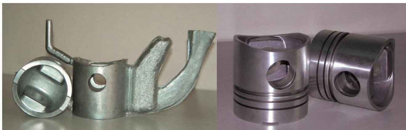
Рисунок 11 – Поршни из сплава АК21М2,5Н2,5: а) отливка с литниковой системой; б) после механической обработки.
