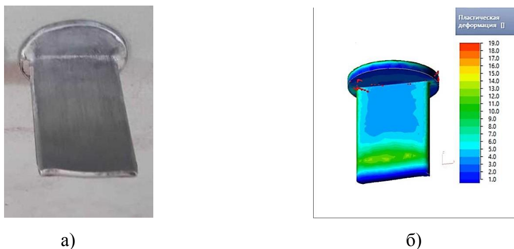
Рисунок 47 - Вид полуфабрикатов контакта предохранителя, полученных на основе физического (а) и компьютерного (б) моделирования из заготовки, изготовленной поперечной осадкой
