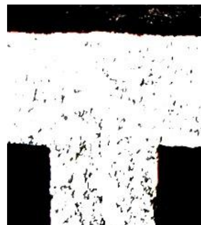
Рисунок 54 - Макрошлифы осевой зоны выдавленной ножевой части контакта с образованием (а) и без образования (б) дефекта - утяжины
