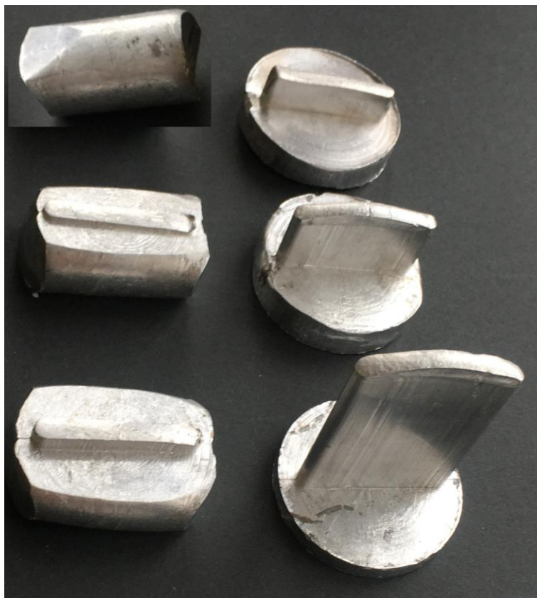
Рисунок 45 – Стадии формоизменения осадки – выдавливания отрезанной от прутка заготовки при изготовлении полуфабриката контакта
