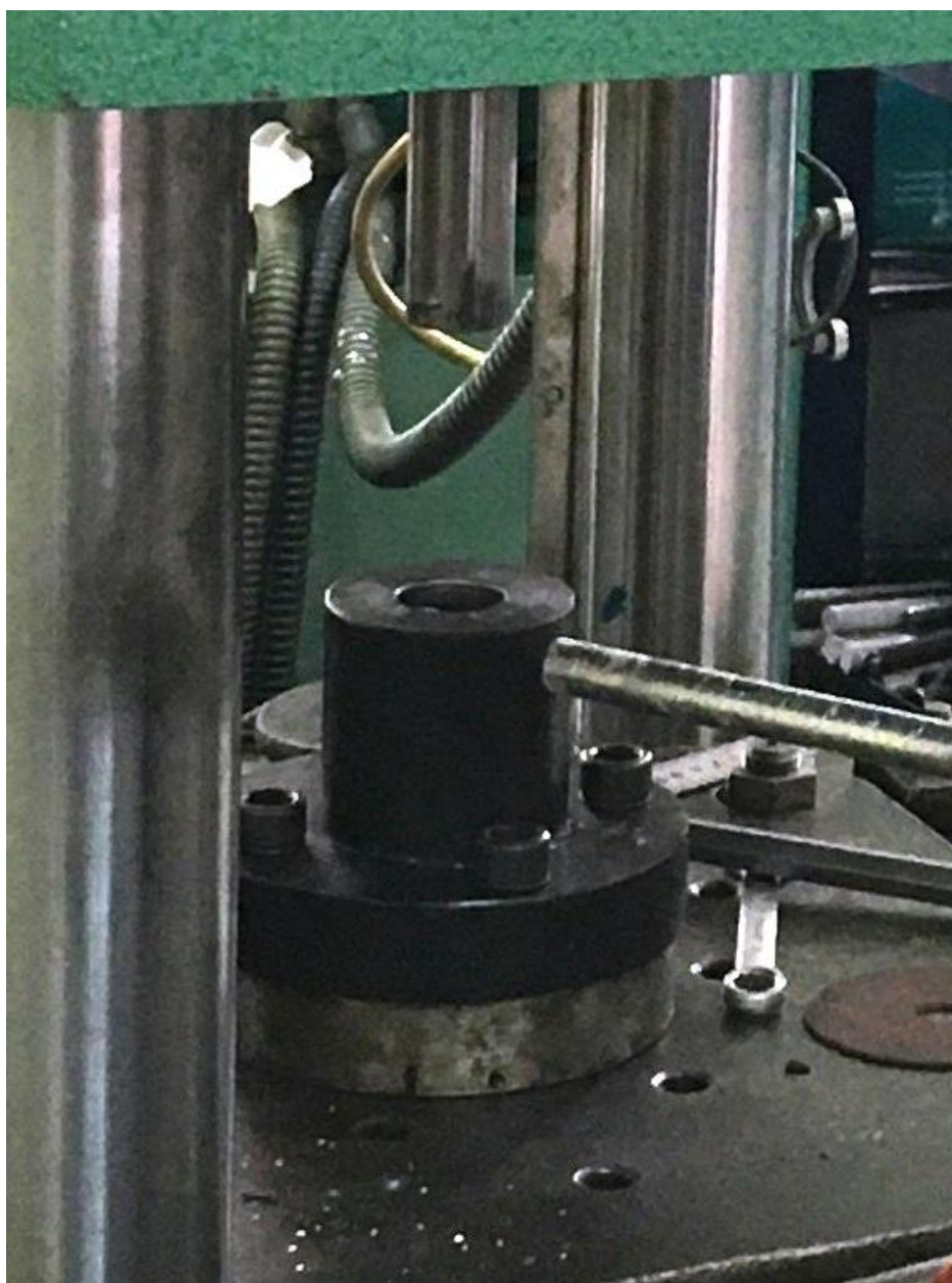
Рисунок 44 – Опытный для отрезки – штамповки, установленный на прессе
