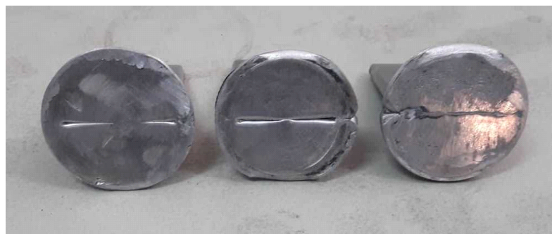
Рисунок 9 – Общий вид основания отштампованных контактов с зарождением (а), развитием (б) и разрушением (в) дефекта утяжина
