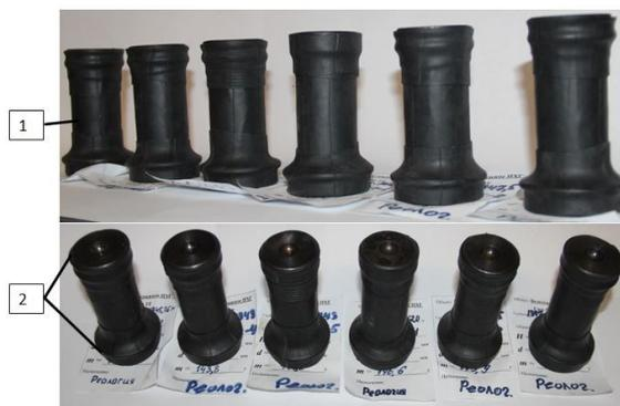
**Рисунок 3.3** – Подготовленные образцы для проведения испытаний. 1 – металлические плашки; 2 – герметичная оболочка
