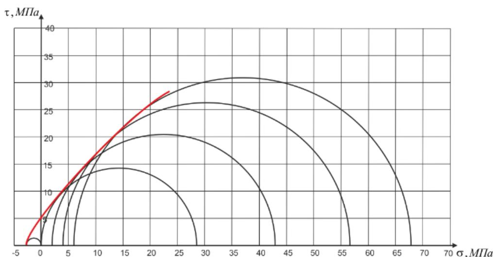
**Рисунок 1.5** –. Пример паспорта прочности каменной соли, полученный в лабораторных условиях [6]
