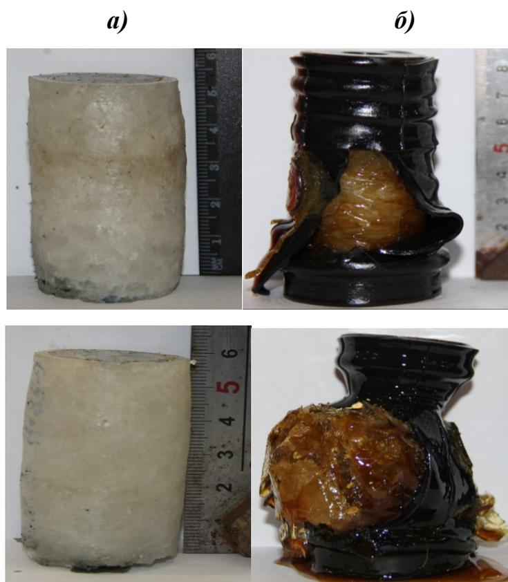
**Рисунок 3.8** – Фотографии образцов после эксперимента на ползучесть. *а)* – без пробоя оболочки; *б)* – с пробоем оболочки
