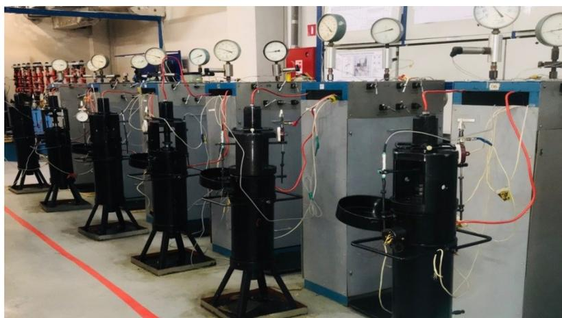
**Рисунок 3.2** - Общий вид установок трехосного сжатия БУ -61
