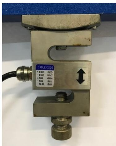
**Рисунок 2.5** – Датчик силы АЦДС-50/1И-0,5
