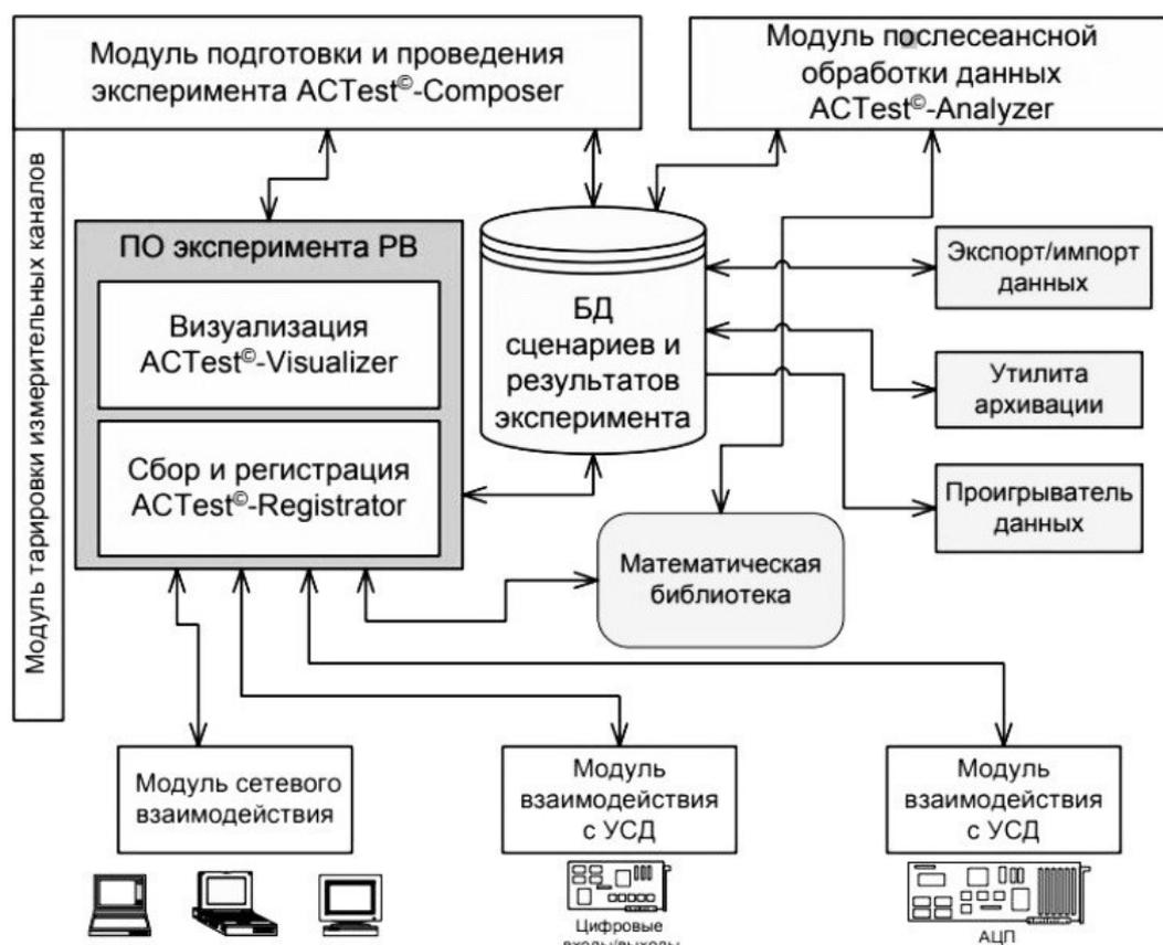
**Рисунок 3.7** - Структура программного обеспечения комплекса ACTest
