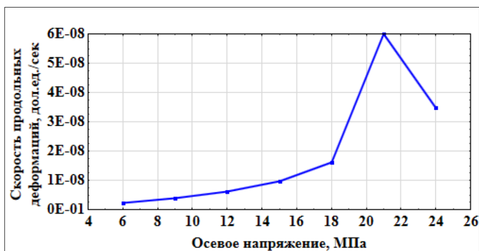
Рисунок 3 – Графическая зависимость скорости продольного деформирования образца от напряжения
