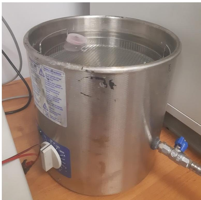
Рисунок 4.9 – Чистка образцов в ультразвуковой ванне в растворе универсального обезжиривателя
