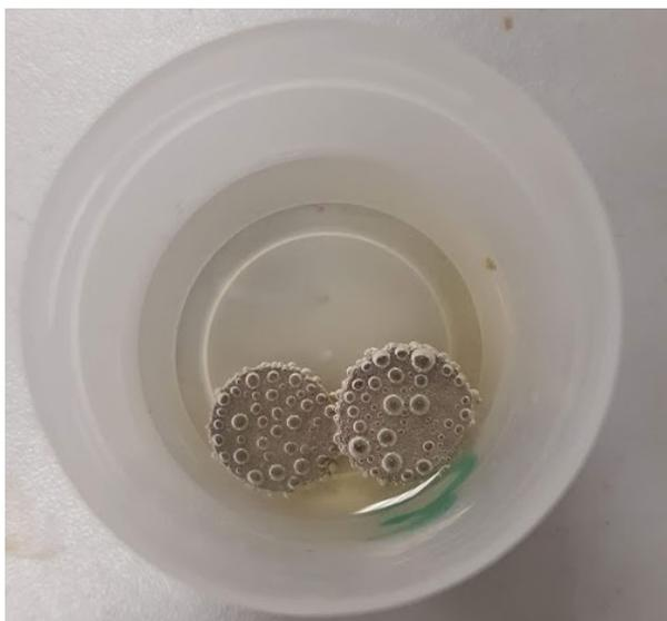
Рисунок 4.7 – Травление пеноматериала в растворе  $1\text{HF} : 4\text{HNO}_3 : 5\text{H}_2\text{O}$
