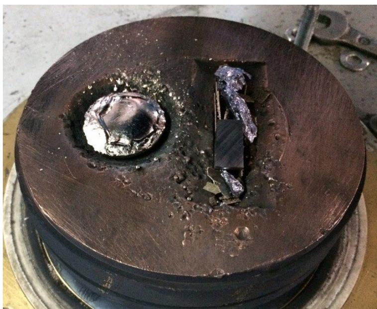
Рисунок 2.3 – Изображение медного кристаллизатора с шихтой и геттером
