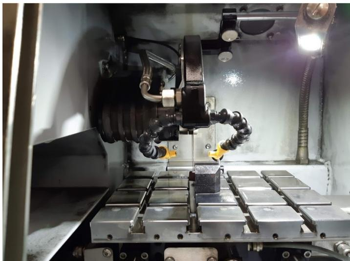
Рисунок 4.6 – Механическая резка образца, заполненного воском
