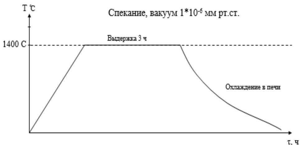
Рисунок 2.10 – Кривая нагрева при проведении спекания
