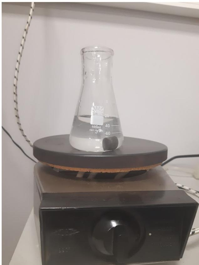
Рисунок 4.8 – Очистка образцов путём кипячения в дистиллированной воде в течение 60 минут.
