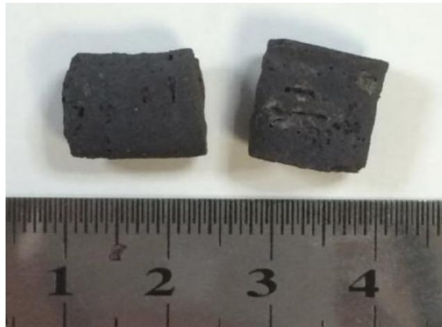
Рисунок 2.9 – Образцы пеноматериалов после пиролиза без контроля скорости нагрева
