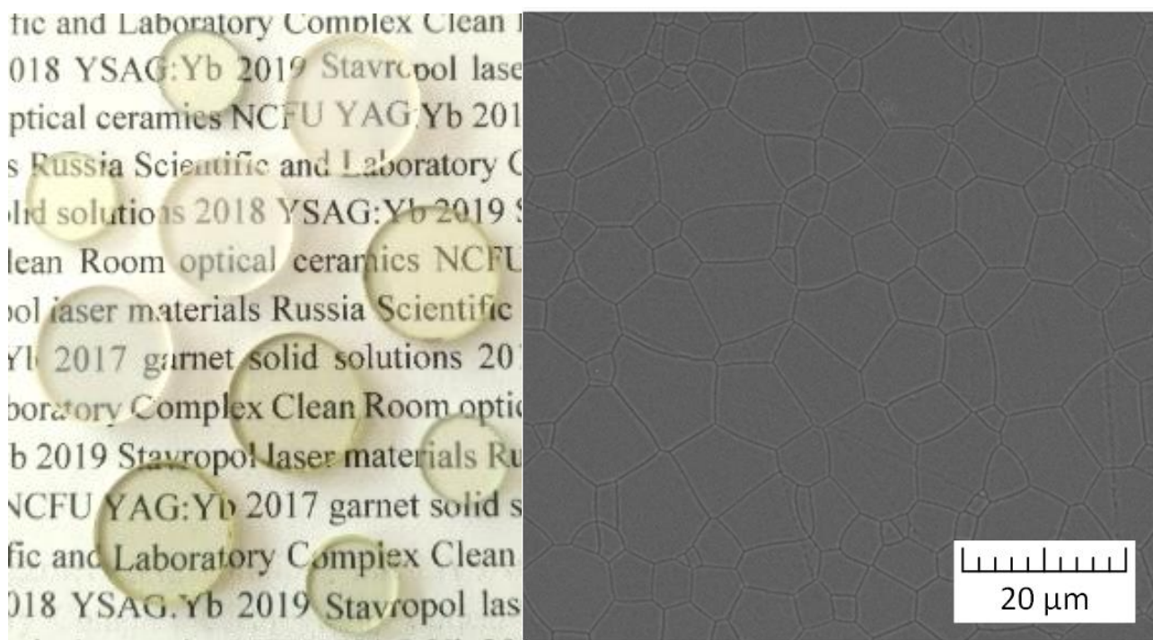
Рисунок 3.23 – Внешний вид образцов оптической керамики (способ SR ) и микрофотография поверхности керамики после термического травления
