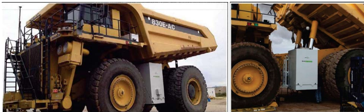
Рисунок 2.23 – Автосамосвал Komatsu 830E-AC, работающий в газодизельном режиме
