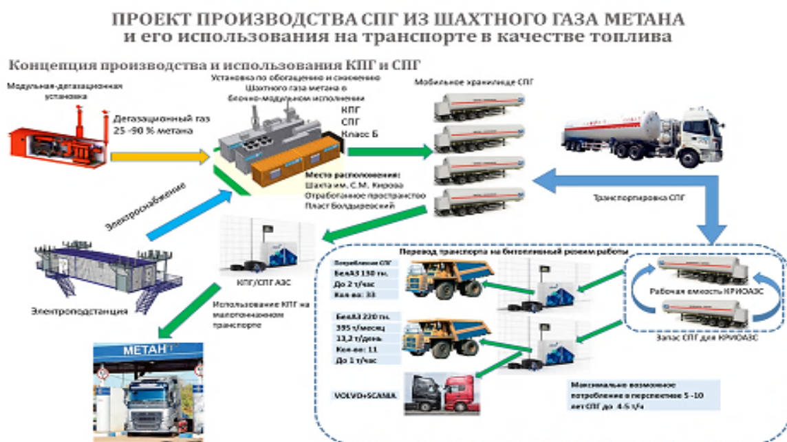
Рис.3.1 - Основные технологические схемы и технические средства улавливания и утилизации метана в рамках Управления дегазации и утилизации метана АО «СУЭК-Кузбасс»
