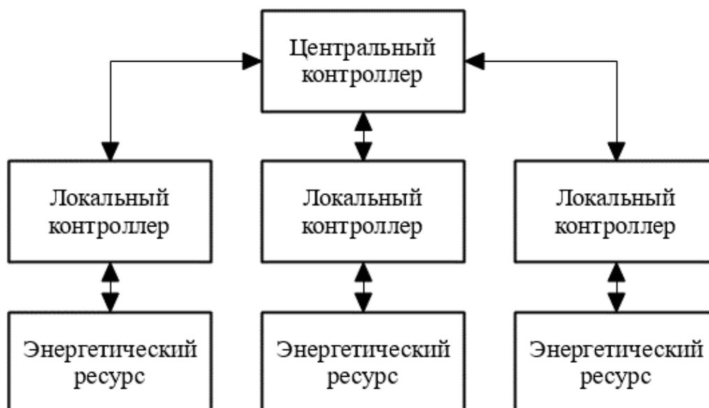
Рис 1.26 - Схема парадигмы централизованного управления
