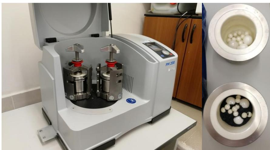
Рис.3.14 б – процесс измельчения пасты
