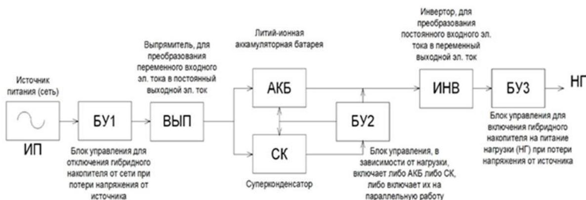
Рис 1.30 - Структурная схема гибридного накопителя энергии
