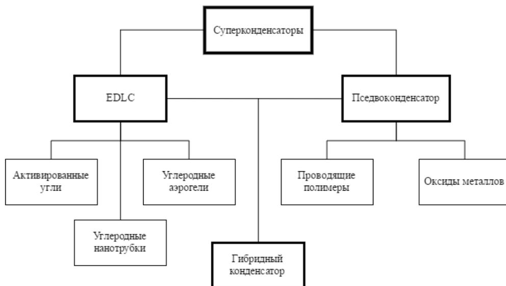
Рис 1.7 – Типы суперконденсаторов и соответствующие материалы электродов.[13]
