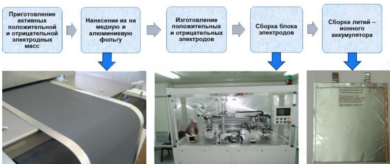
Рис 1.20 Перечень процессов производства ХИТ и СКС по толстопленочной технологии [42]
