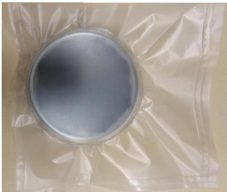
Рис.3.31– Пропитанный металлизированный электродный материал, герметично упакованный в защитную пленку
