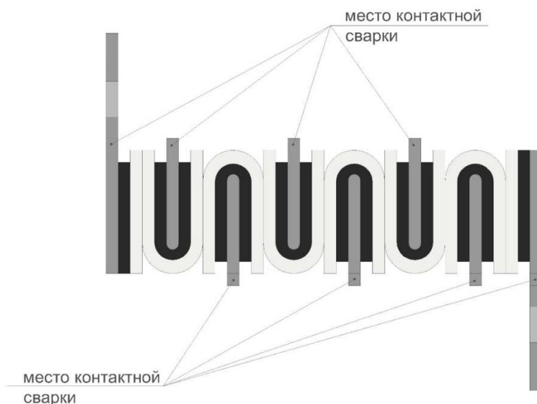
Рис.3.40 – Схема сборки конденсаторной ячейки
