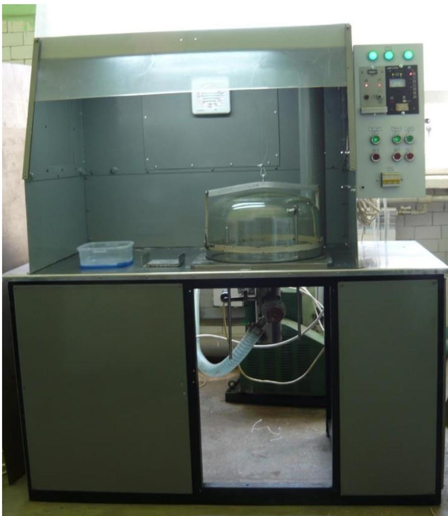
Рис.3.29 - Экспериментальная установка вакуумной пропитки жидким электролитом
