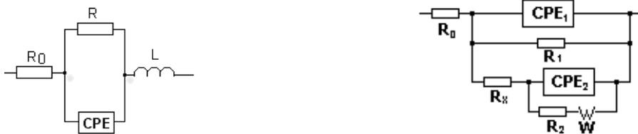
Рис.3.12 Эквивалентная схема 1    Рис.3.13. Более сложная эквивалентная схема 2
