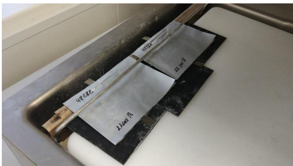
Рис.3.41 – Сварка краев корпуса ячейки СКС
