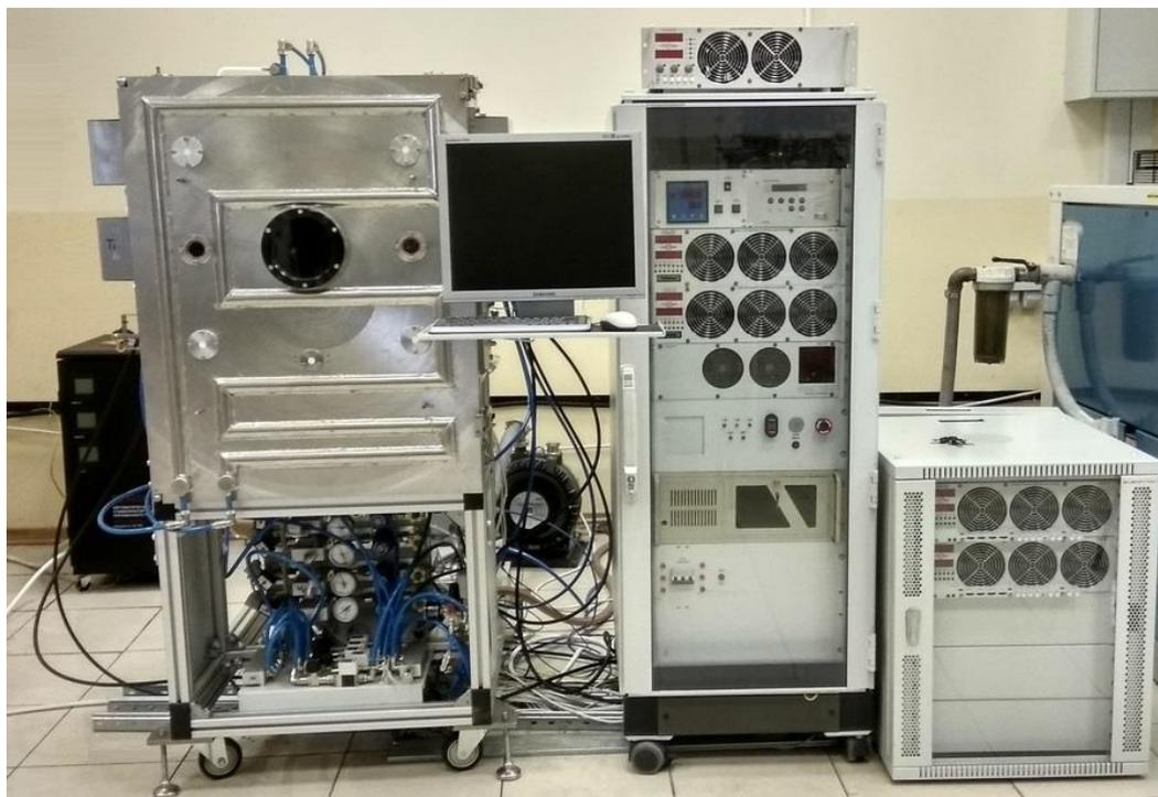
Рис.3.1 - Вакуумная установка для металлизации МАГНА ТМ Р
