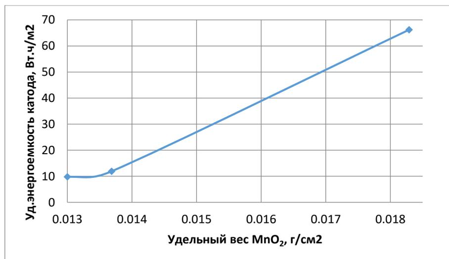
Рис.3.52 – Зависимость удельной энергоёмкости катода от удельного веса  $MnO_2$
