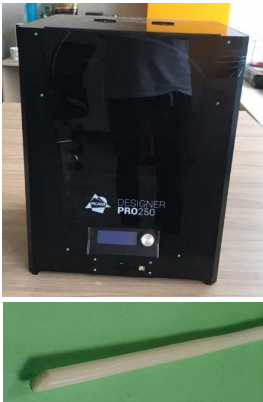
Рисунок 4.18 - Внешний вид принтера PICASO Designer 250PRO и полученного стренга для печати
