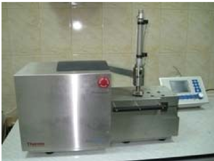
Рисунок 4.17 - Внешний вид лабораторного экструдера Thermo Scientific Haake MiniJet
