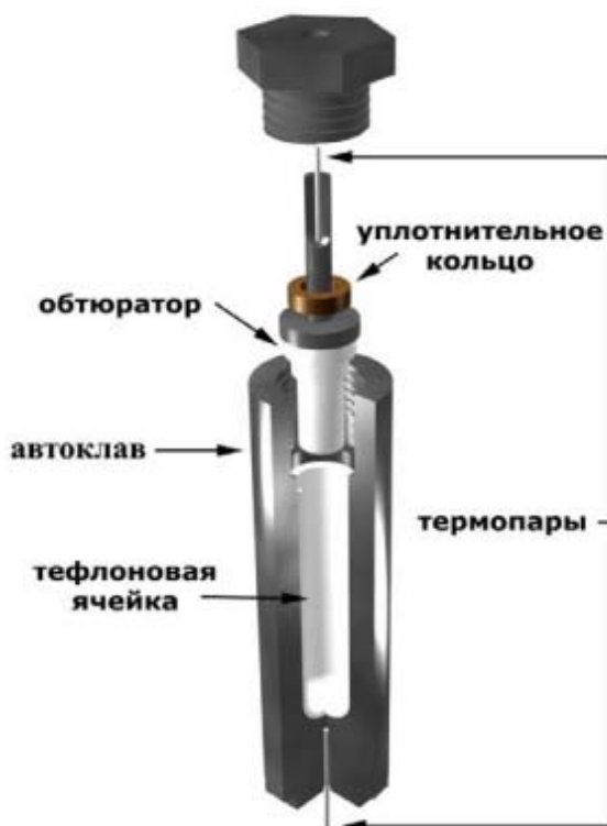
Рисунок 2.4 – Схема автоклава
