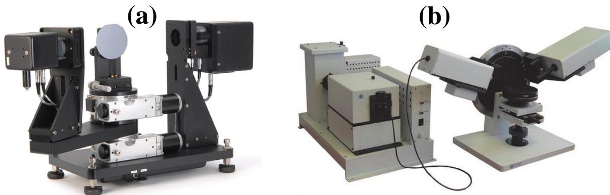
**Рисунок 2.5-** а) J.A.Woollam спектроскопический эллипсометр (VASE); б) спектральный эллипсометр (Ellipse 1891).
