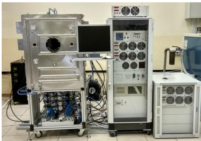
Рис.3. - Вакуумная установка для металлизации МАГНА ТМ Р
