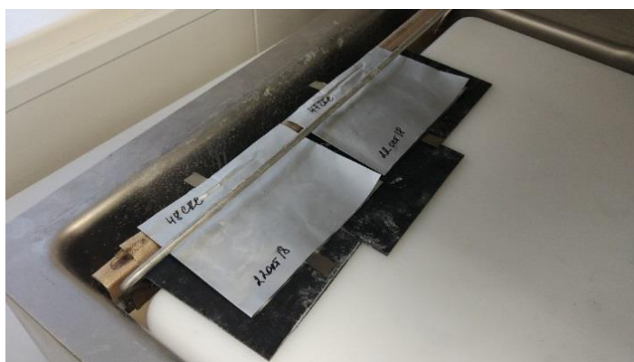
Рис.12 – Сварка краев корпуса ячейки СКС
