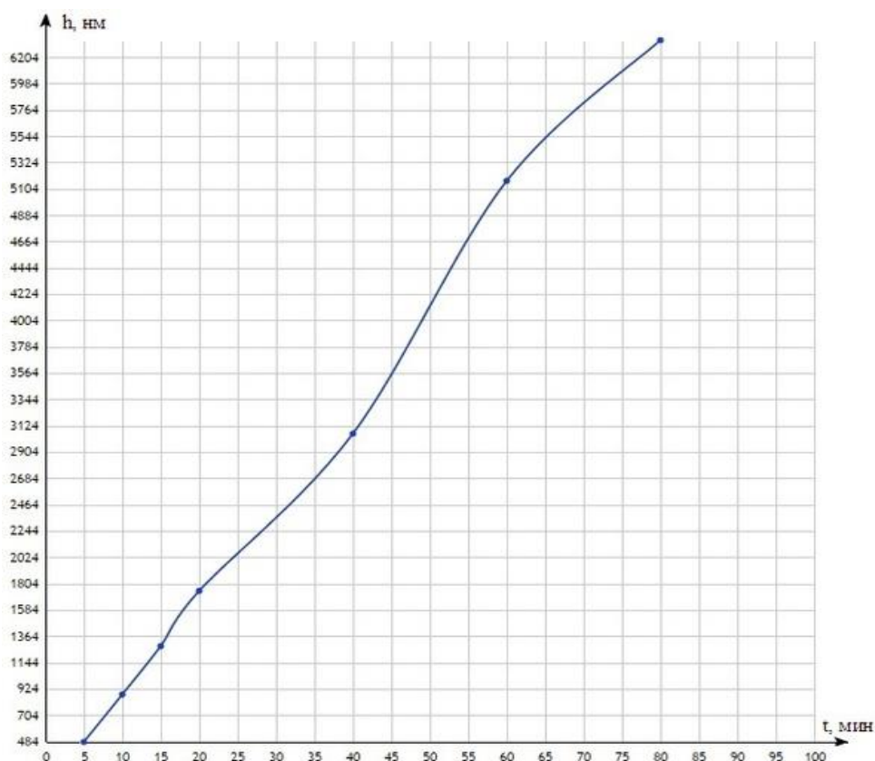
Рис.4.Зависимость толщины покрытия Ti от времени
