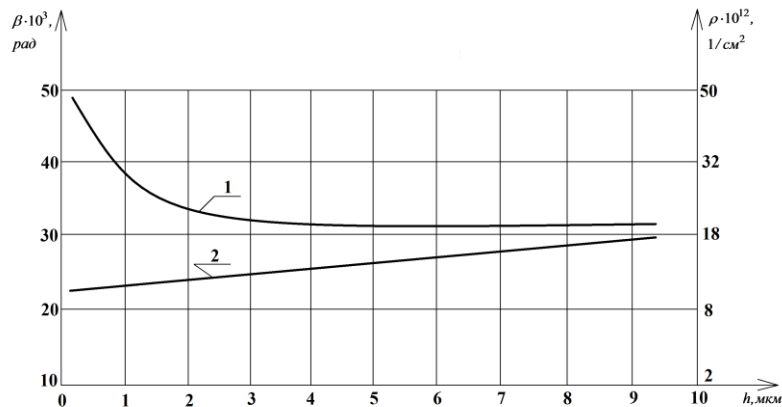
Рисунок 2.10. – Градиенты \beta и \rho по глубине трибослоя для стали 25Х3МЗНБЦА: 1 – исходное состояние; 2 – после 8-ми часового трения с маслом И-45
