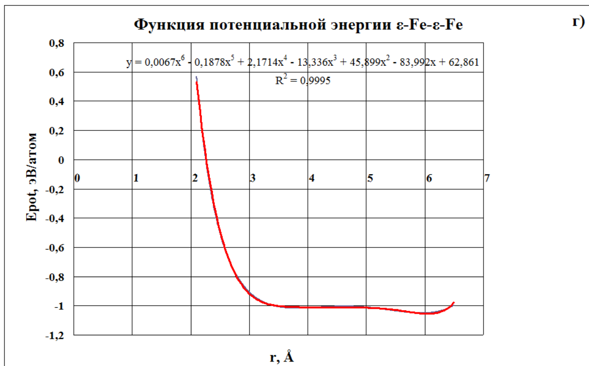
Рисунок ПВ.2. – Функции ПМВ для \varepsilon -Fe: а – функция парного взаимодействия; б – функция электронной плотности; в – функция вложения; г – функция потенциальной энергии
