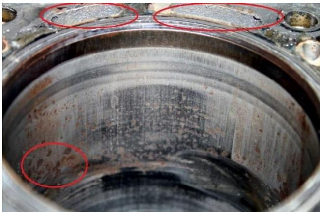
Рисунок 4.22 - Фреттинг – коррозия на поверхности цилиндра
