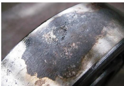
Рисунок 4.23 - Разрушение контактируемой поверхности поршня, обусловленное фреттинг – коррозией
