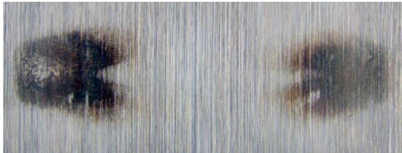
Рисунок 4.21- Начальное образование пятен фреттинг – коррозии на поверхности цилиндра
