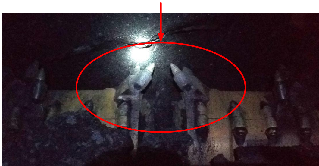
Рисунок 1.7 – Фотография месторасположения форсунок на баре проходческого комбайна Sandvik
