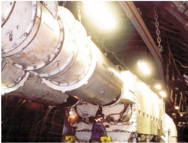
Рисунок 1.17 – Система сухого обеспыливания компании CFT (фотография и принципиальная схема работы) [27]
