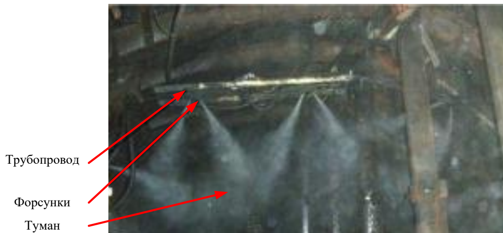
Рисунок 1.9 – Фотография работы системы обеспыливания [28]
