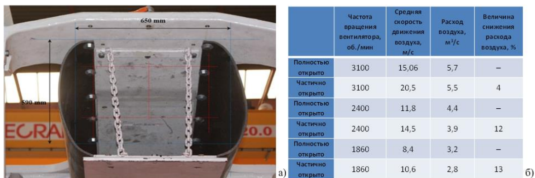
Рисунок 2.4 – Фотографии первой части скруббера (а) и экспериментальные значения работы гидравлического вентильатора ES6-150HY при работе в лаборатории без пыли и воды (б)
