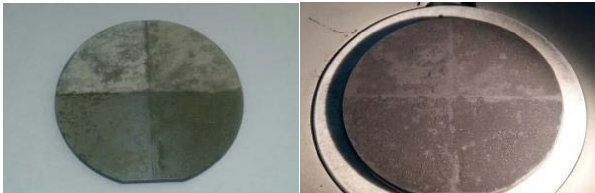
А – Внешний вид образца после нанесения алмазного порошка, Б – Внешний вид образца после проведения процесса осаждения алмаза из газовой фазы
