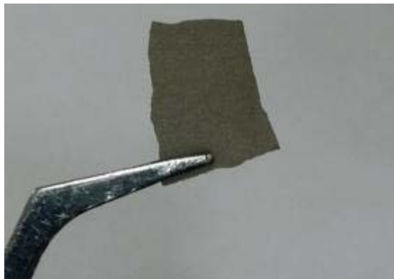
Рисунок 164 – Внешний вид исходной белой алмазной пленки
