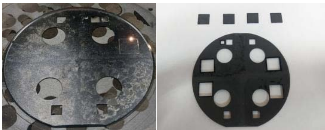
Рисунок 186 – Лазерная резка экспериментальных образцов для измерения теплопроводности
