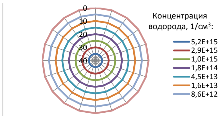
Рисунок 102 – Распределение атомарного водорода в плазменном разряде
