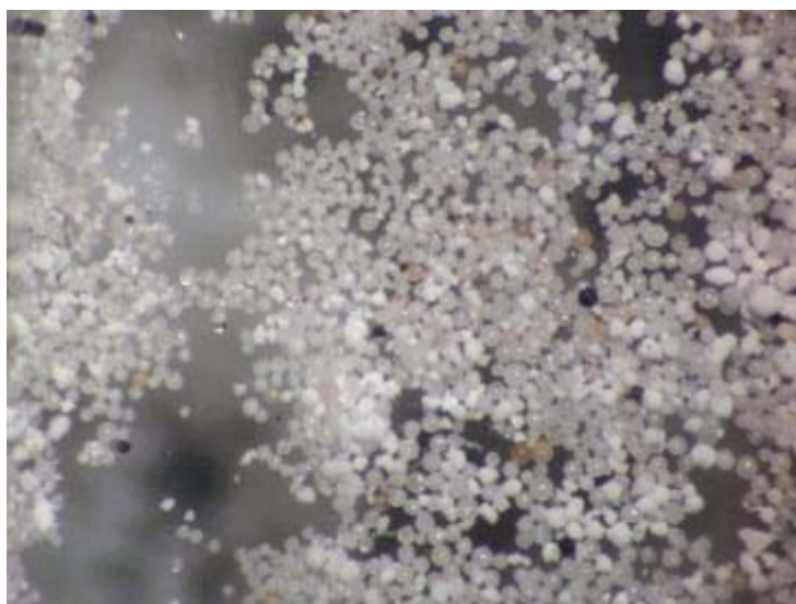
Рисунок 134 – Внешний вид порошка после процесса сфероидизации
