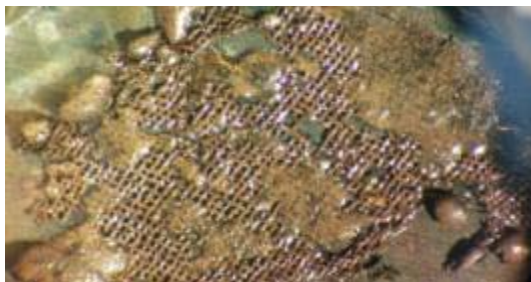
Рисунок 62 – Расплавление медной сетки в результате перегрева
