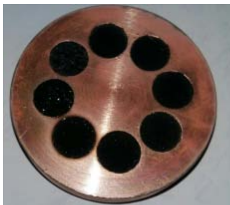
Рисунок 74 – Медный пьедестал после осаждения алмаза при прокачке газа через алмазные порошки
