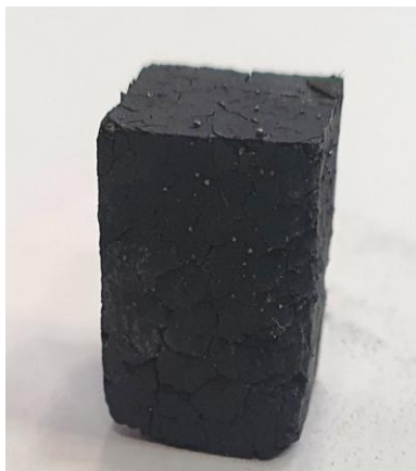
Рисунок 88 – Образец Fe:BN=1 с добавкой в порошковую смесь 10 масс. % эвтектического сплава Al – Si после отжига в азоте при температуре 600 °С, 2 ч
