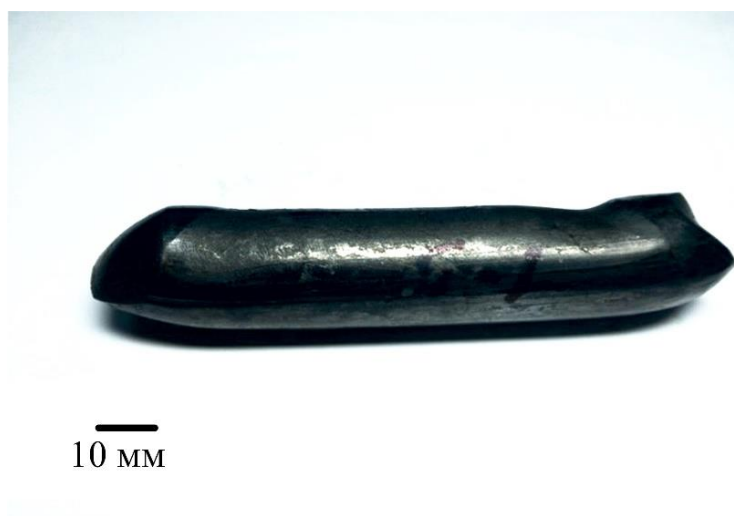
Рисунок 30 – Общий вид заготовки СПФ ТН-1 после квазинепрерывного РКУП при 400 °С за 5 проходов
