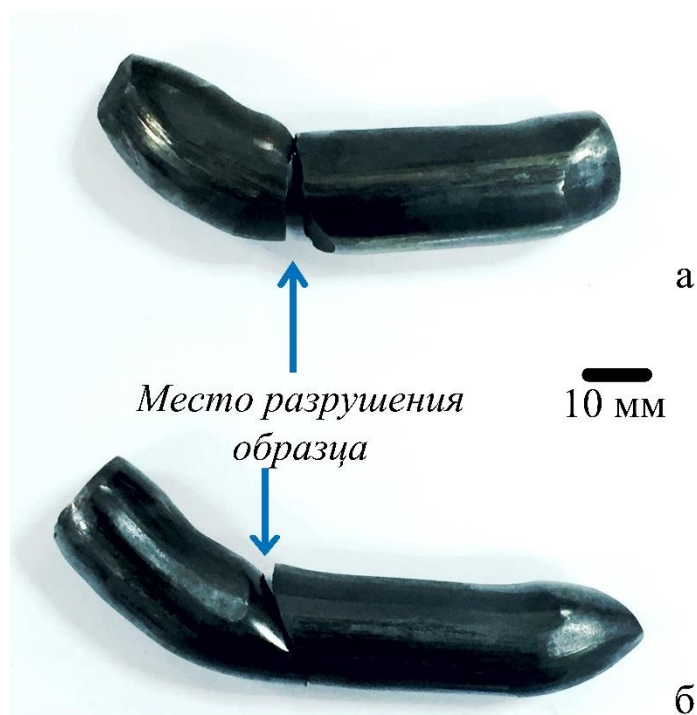
Рисунок 31 – Фотографии образцов СПФ ТН-1 после проведения РКУП с углом пересечения каналов 120°: РКУП 2350 (а) и РКУП 380 (б)
