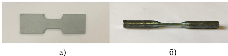
Рисунок 25 – Общий вид образцов для испытаний на растяжение: плоский образец, вырезанный из заготовки после РКУП (а), цилиндрический образец, выточенный из заготовки после ТРК (б)
