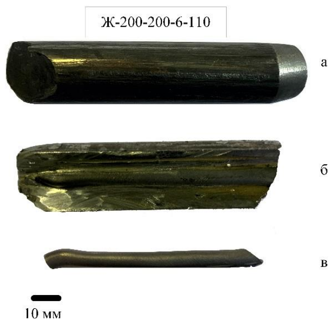
Рисунок 62 – Фотографии образца СПФ Ti-Ni 6 мм после применения РКУП в оболочке из чистого железа при температуре 200 °С и \varphi = 110^\circ
