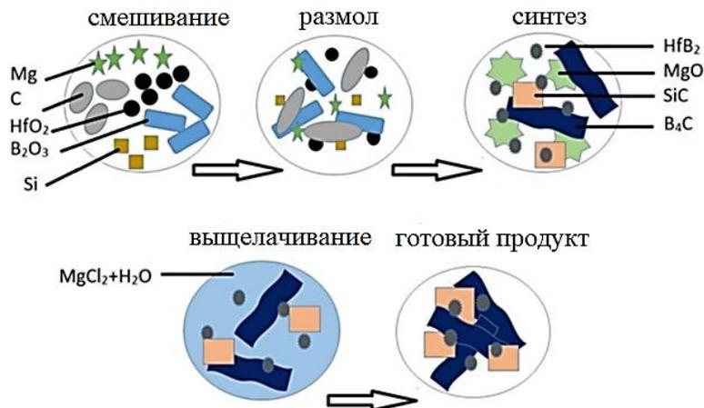
Рисунок 15 – Механизм синтеза  $V_4C-SiC-HfB_2$  магнийтермическим восстановлением оксидных прекурсоров [88]
