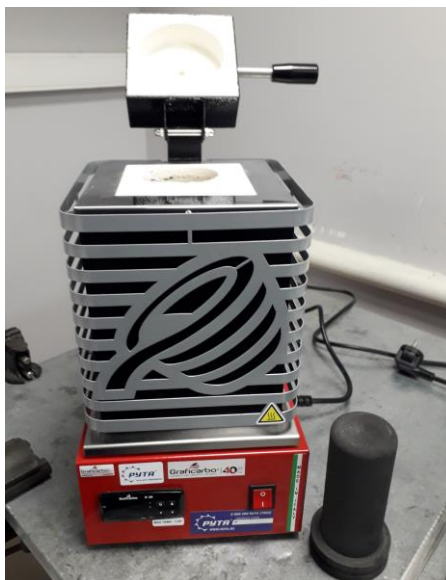
Рисунок 2.1 - Электропечь GF 1100 N2D (Graficarbo, Италия)
