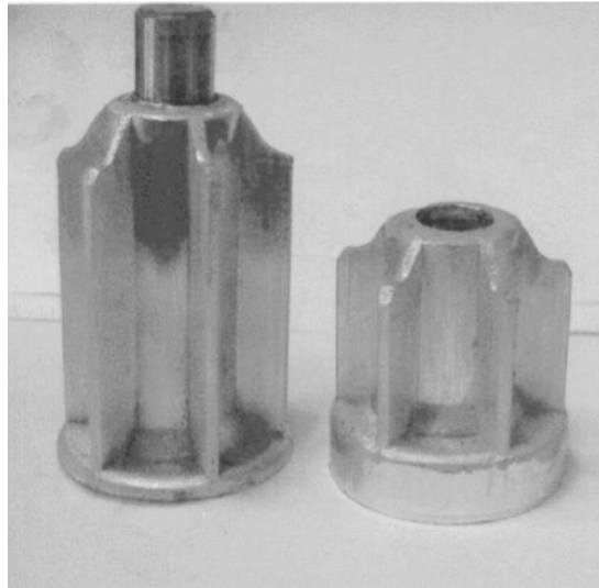
Рис.4.3. Поковка с 6-ю продольными рёбрами на разных этапах деформирования
