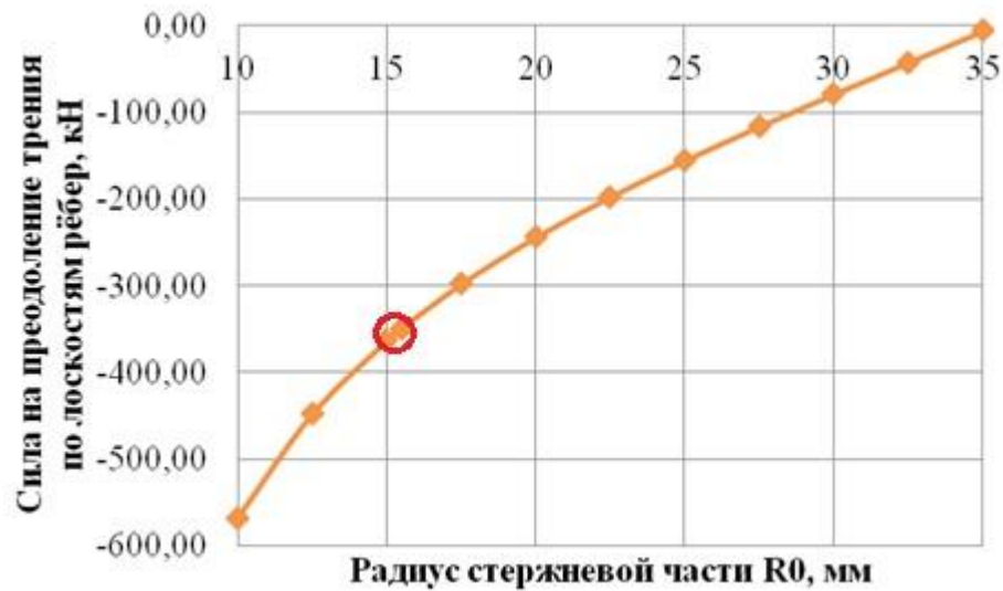
Рис. 2.14. Влияние радиуса стержневой части поковки на силу трения
