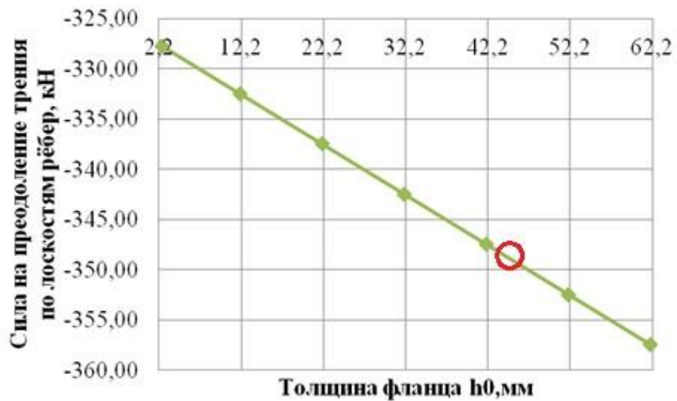
Рис. 2.13. Связь силы на преодоление трения с толщиной фланца
