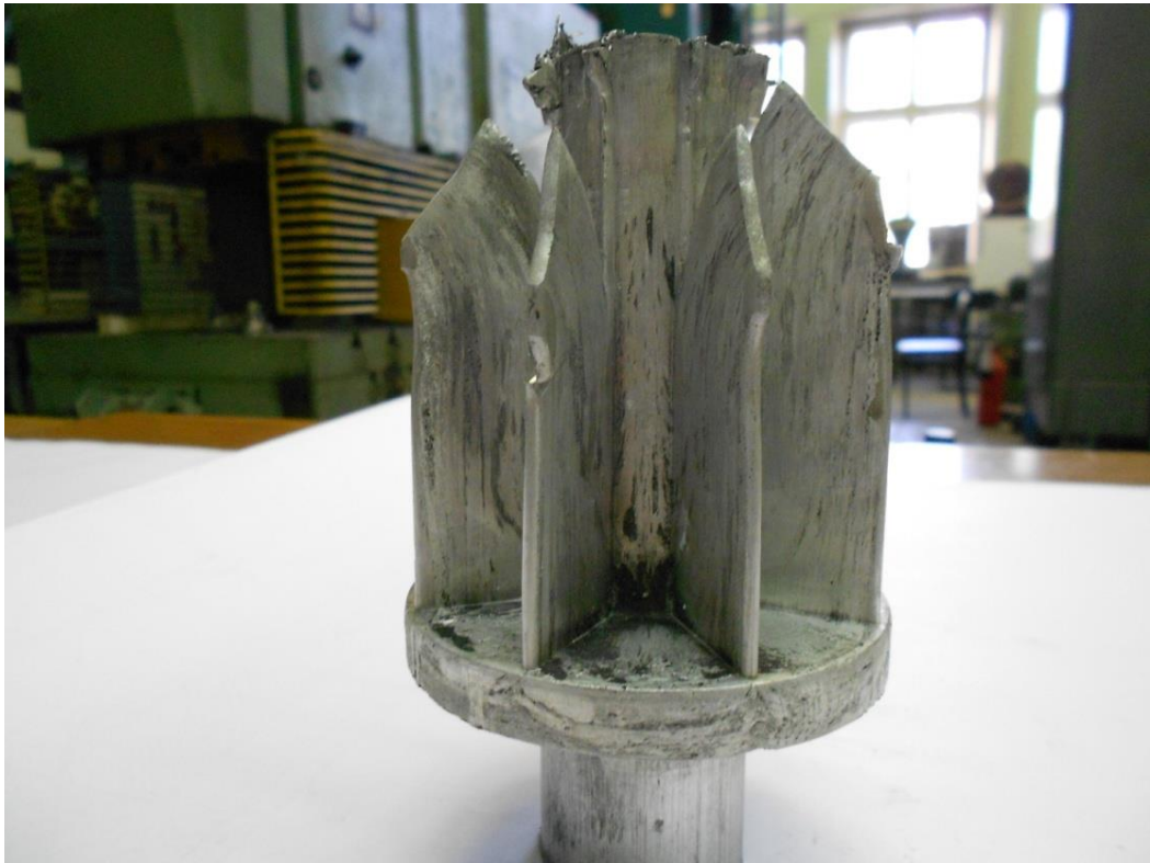
Рис. 4.2. Отрыв рёбер от стержневой части поковки
