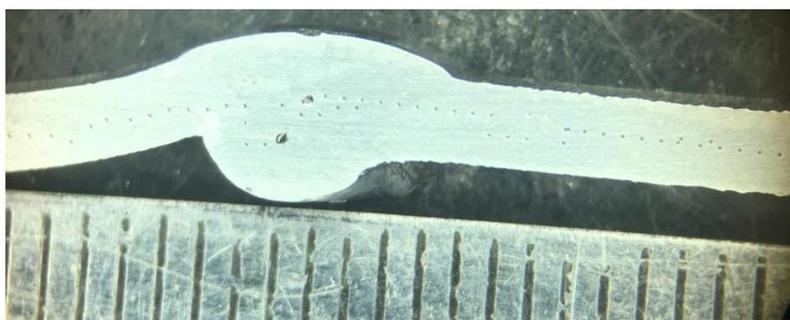
Рисунок 6.9 – Отпечатки индентора после измерения твердости в образце «AlCa-1»
