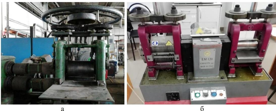
Рисунок 2.2 – Оборудование для получения деформированных полуфабрикатов: а – стан горячей прокатки ДУО210; б – электромеханические вальцы LM120
