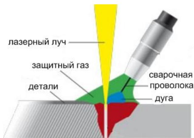
Рисунок 1.12 – Схема лазерно-дуговой сварки
