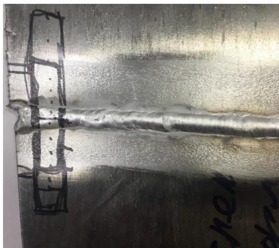
Рисунок 6.5 – Фотография вырезки образцов для анализа структуры
