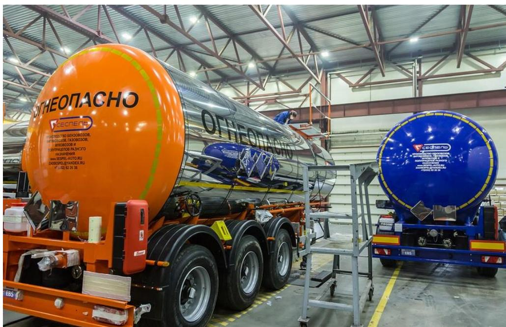
Рисунок 1.22 – Сварная автоцистерна из алюминиевого сплава
