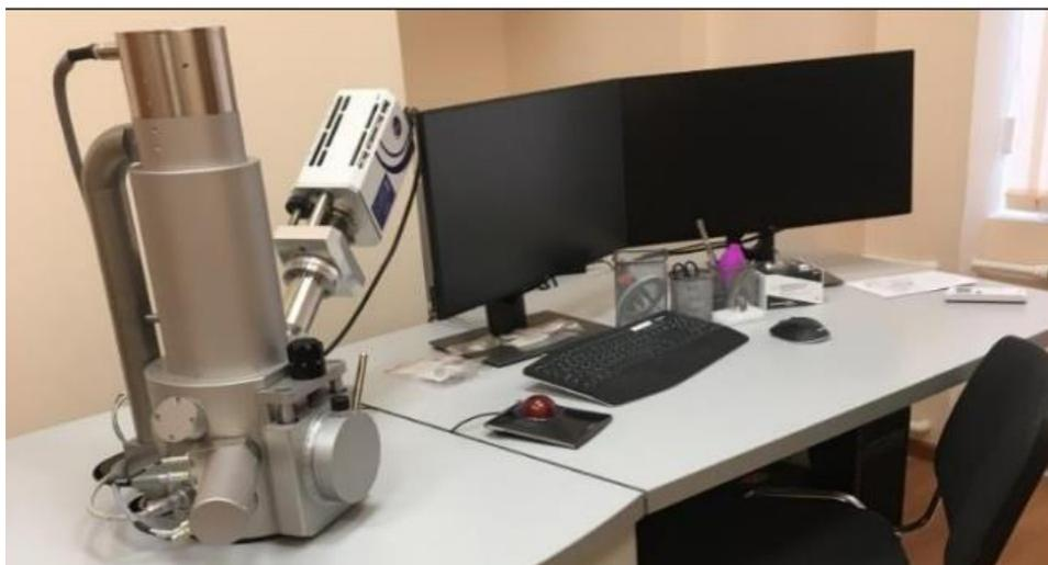
Рисунок 2.6 - СЭМ TESCAN VEGA3
