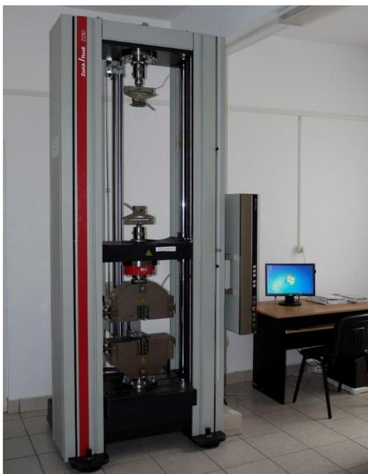
Рисунок 2.9 - Испытательная машина Zwick/Roell Z250
