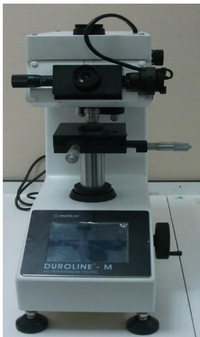
Рисунок 2.5 - Твердомер Metkon Duroline MH-6
