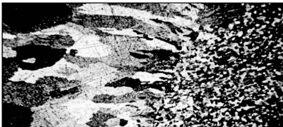
Рисунок 1.20 - Крупные кристаллиты в зоне сплавления шва с основным металлом в сварном соединении сплава АМг [2]
