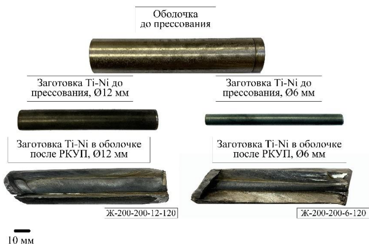
Рисунок 14 – Фотографии образцов СПФ Ti-Ni диаметром 6 и 12 мм после применения РКУП в оболочке из чистого железа при температуре 200 °С и \varphi = 120^\circ
