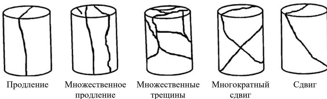
Рисунок 1.13 – Типы разрушения образца [53]
