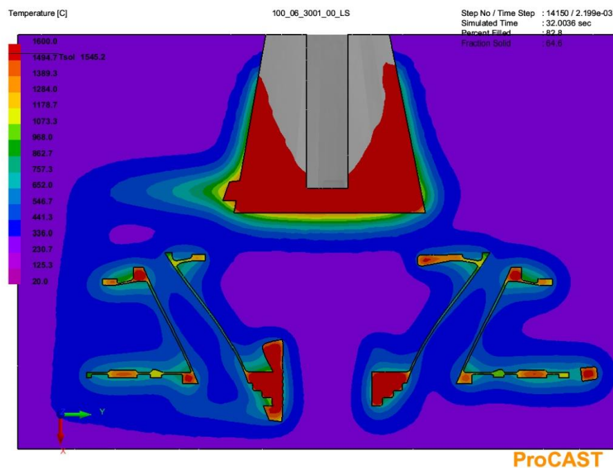
Рисунок 63 – Температурные поля в отливке и форме «Втулка» спустя 32 секунды с начала заливки.
