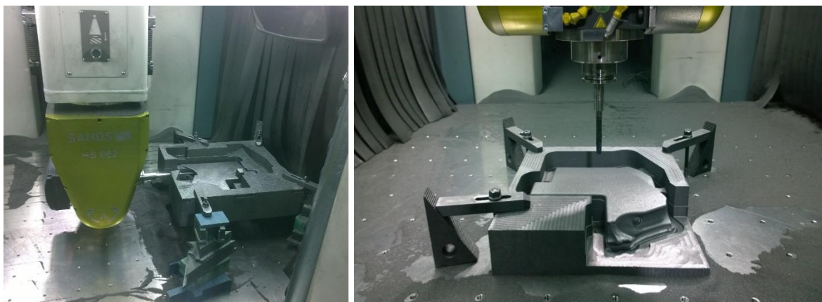
Рисунок 37 – Изготовление элементов графитовой формы на станке Dynamic 3000 FC
