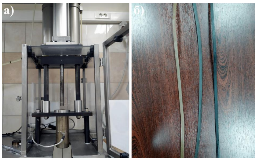
Рисунок 2.5 - экструзия СВМПЭ плунжера экструдера UE-MSL (а), экструдированные гели (ксерогель) (б)
