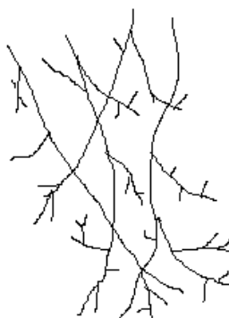
Рисунок 2.1 - упрощенное представление цепочки ПЭ-воска с определенной степенью разветвленности
