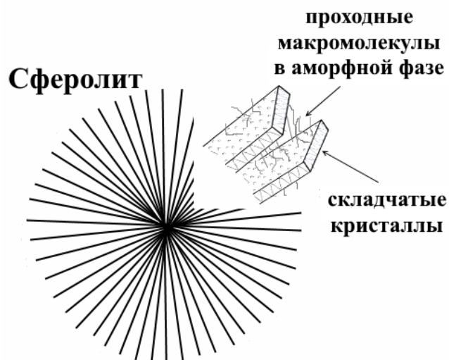
Рисунок 1.4 - схематическое изображение сферолитной структуры
