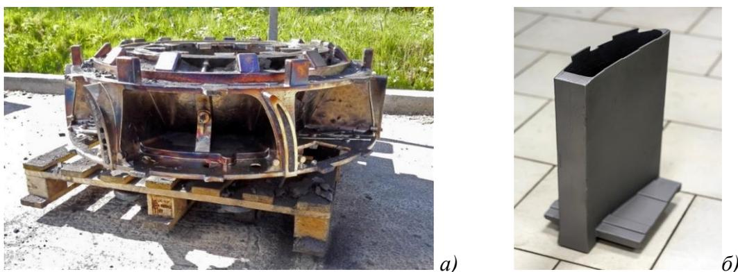
Рисунок 10 – Отливки из сплава ВТ20Л а) «Втулка» б) «Стойка»
