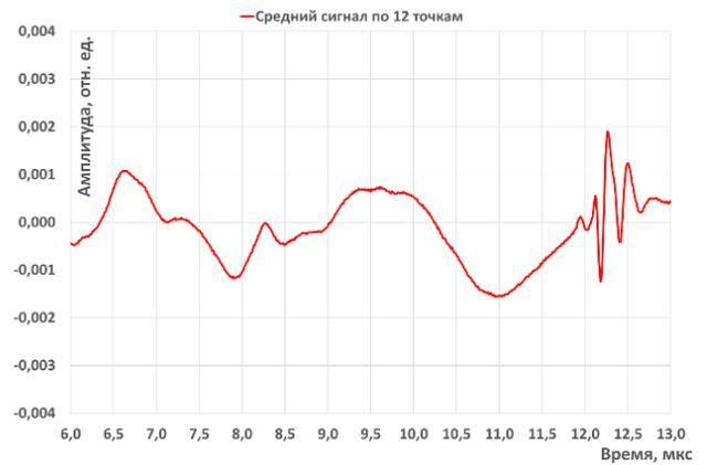
Рисунок В.19 – Временная форма сигнала образца пироксенита, полученная с помощью эхо-режима
