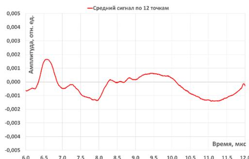
Рисунок В.12 – Временная форма сигнала образца гранита «Мансуровский» толщиной 6,0 мм, полученная с помощью эхо-режима
