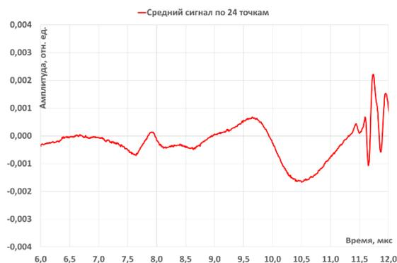
Рисунок В.11 – Временная форма сигнала образца гранита толщиной 11,0 мм, полученная с помощью эхо-режима
