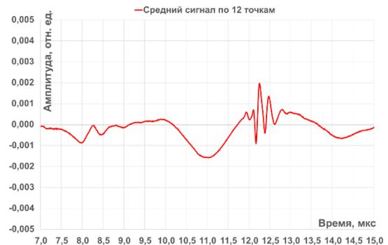
Рисунок В.14 – Временная форма сигнала образца гранита «Мансуровский» толщиной 18,0 мм, полученная с помощью эхо-режима
