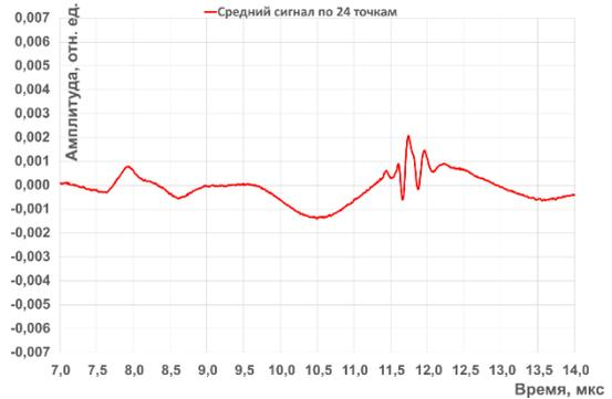
Рисунок В.16 – Временная форма сигнала образца гранита «Мансуровский» толщиной 8,3 мм, полученная с помощью эхо-режима
