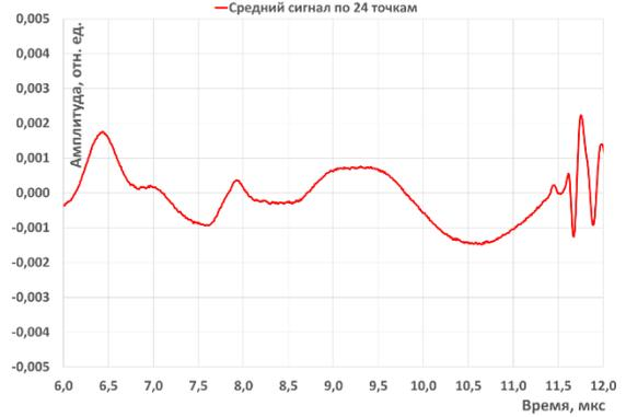
Рисунок В.15 – Временная форма сигнала образца гранита «Возрождение» толщиной 5,1 мм, полученная с помощью эхо-режима
