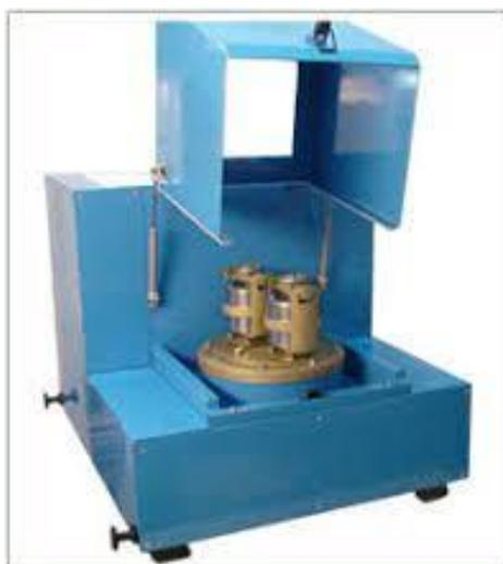
Рисунок 2.4 – Планетарная шаровая мельница «Активатор-2S»
