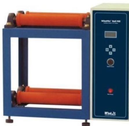
Рисунок 2.3 – Шаровая валковая мельница «Wise Mix»
