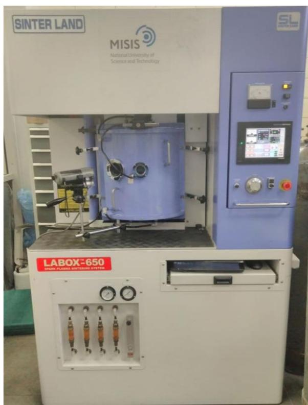
Рисунок 2.8 – Установка искрового плазменного спекания SPS LABOX 650
