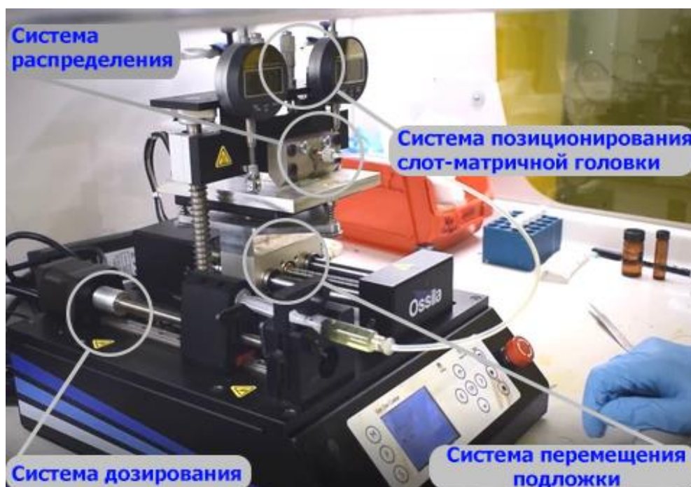
Рисунок 18 – Структура слот-матричного принтера
