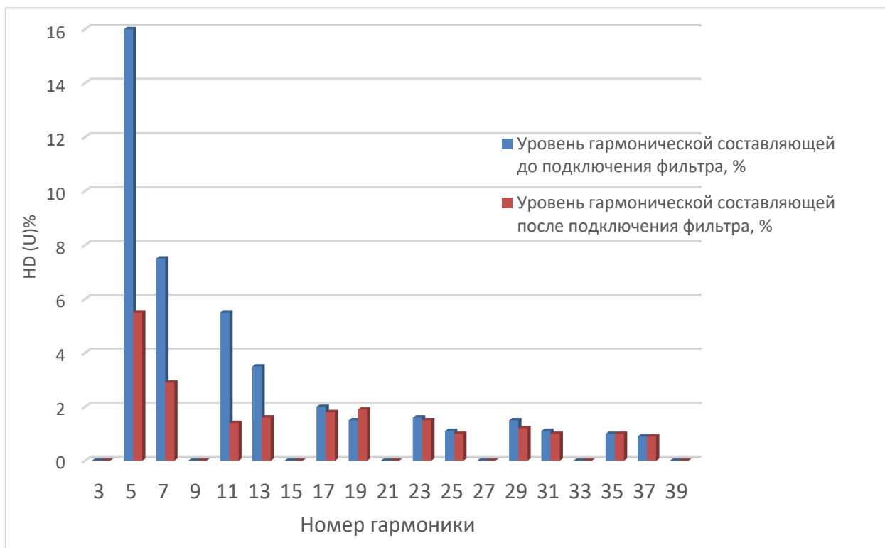
Рисунок 4.28 - Сравнительный анализ гармонического состава по напряжению до и после подключения активного фильтра высших гармоник
