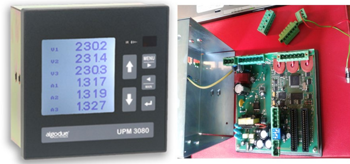
Рисунок 2.6 - Общий вид регистратора параметров электрической энергии производства Algodue Elettronica UPM 3080 (Италия)
