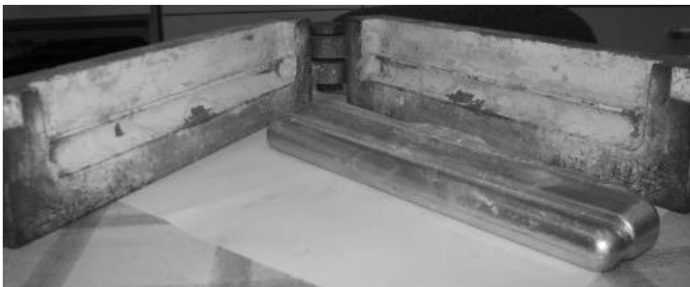
Рисунок 2.1. Изложница для получения слитков с рабочим диаметром 20 мм
