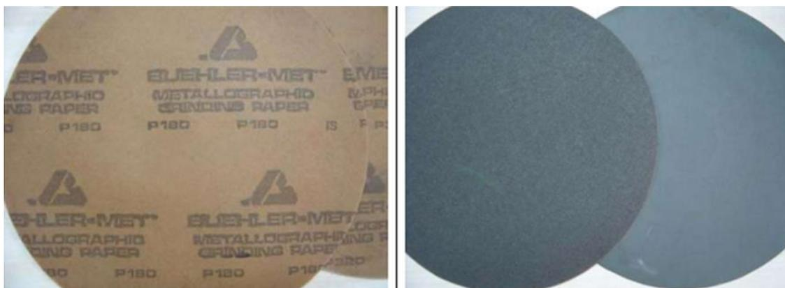
Рисунок 2.11 – Образцы абразивной шлифовальной бумаги
