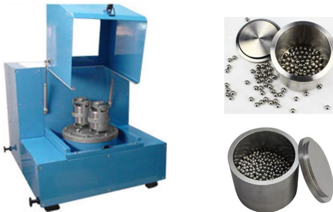
Рисунок 2.6 – Схематическое изображение установки для проведения высокоэнергетического механического помола
