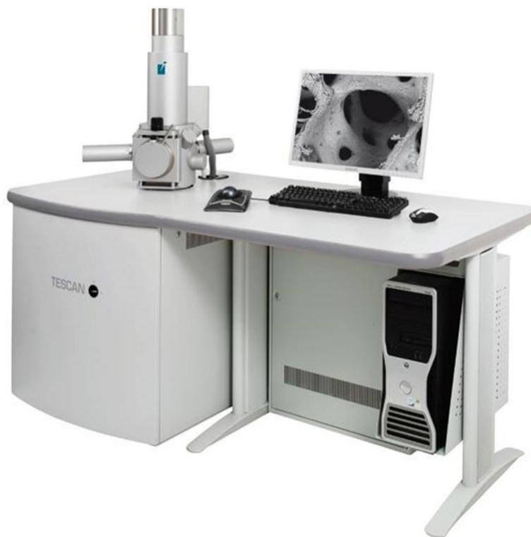
Рисунок 2.16 – Внешний вид сканирующего электронного микроскопа Tescan Vega 3
