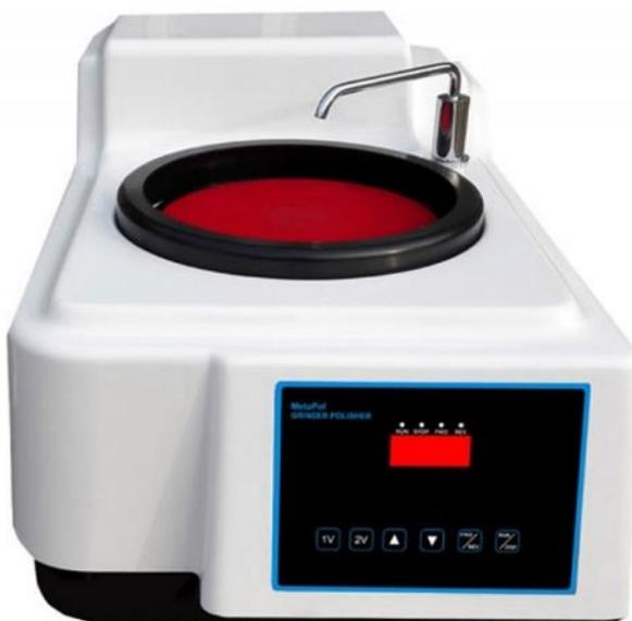
Рисунок 2.12 – Шлифовально-полировальная установка Metapol-160E.
