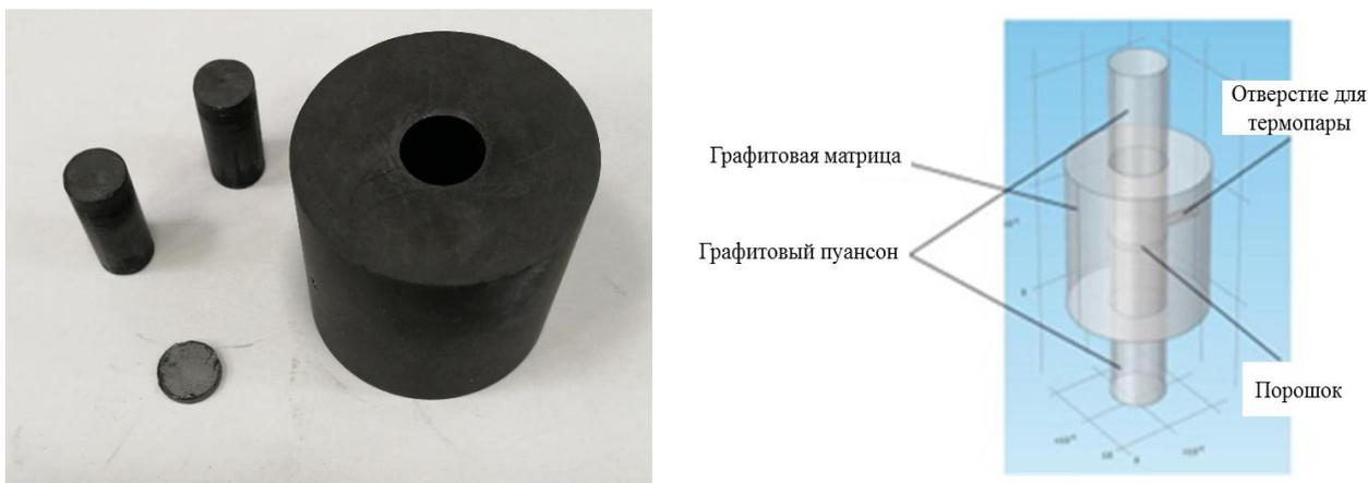
Рисунок 2.7 – Схематическое изображение графитовых матриц, используемых в процессе ИПС
