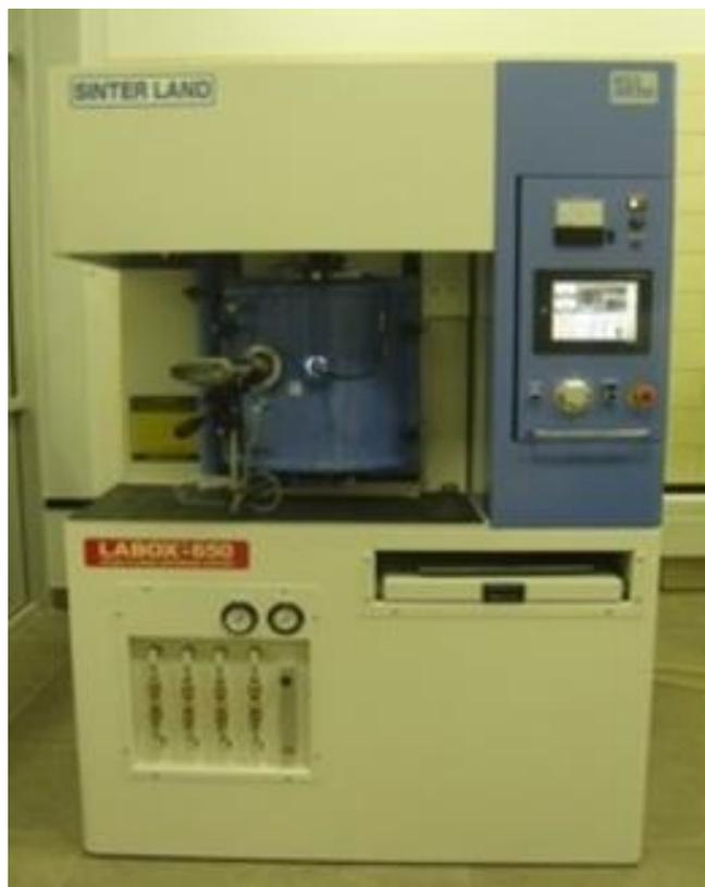
Рисунок 2.8 – Внешний вид установки искрового плазменного спекания Labox 650
