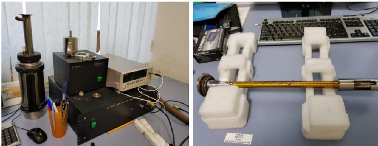
Рисунок 2.22 – Установка для измерения электрофизических свойств
