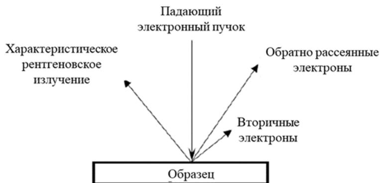
Рисунок 2.17 – Схематичное изображение взаимодействия электронного пучка с веществом
