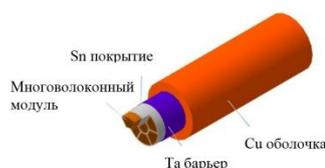
Рисунок 27 - Схема семимодульной композиционной сборки с оборачиванием [154]
