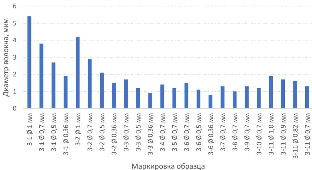
Рисунок 92 - Размеры волокон в образцах различной конструкции с распределенным диффузионным барьером
