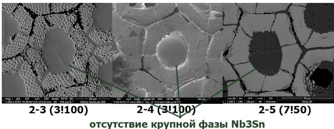
Рисунок 98 – Характерные фрагменты структуры Nb<sub>3</sub>Sn фазы около источника Sn на образцах с общим Nb барьером  $\varnothing$  0,7 мм
