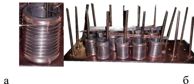
Рисунок 63- Общий вид катушки (а) и комплекта образцов, подготовленных к РТО (б)
