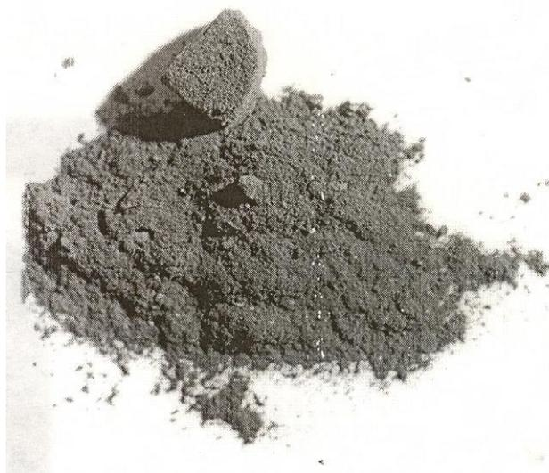
Рисунок 7 – Спеченный магнит  $\text{Nd}_{16}\text{Fe}_{76}\text{B}_8$  подвергнутый испытанию на коррозионную стойкость в течение 158 дней при  $T=85\text{ }^{\circ}\text{C}$
