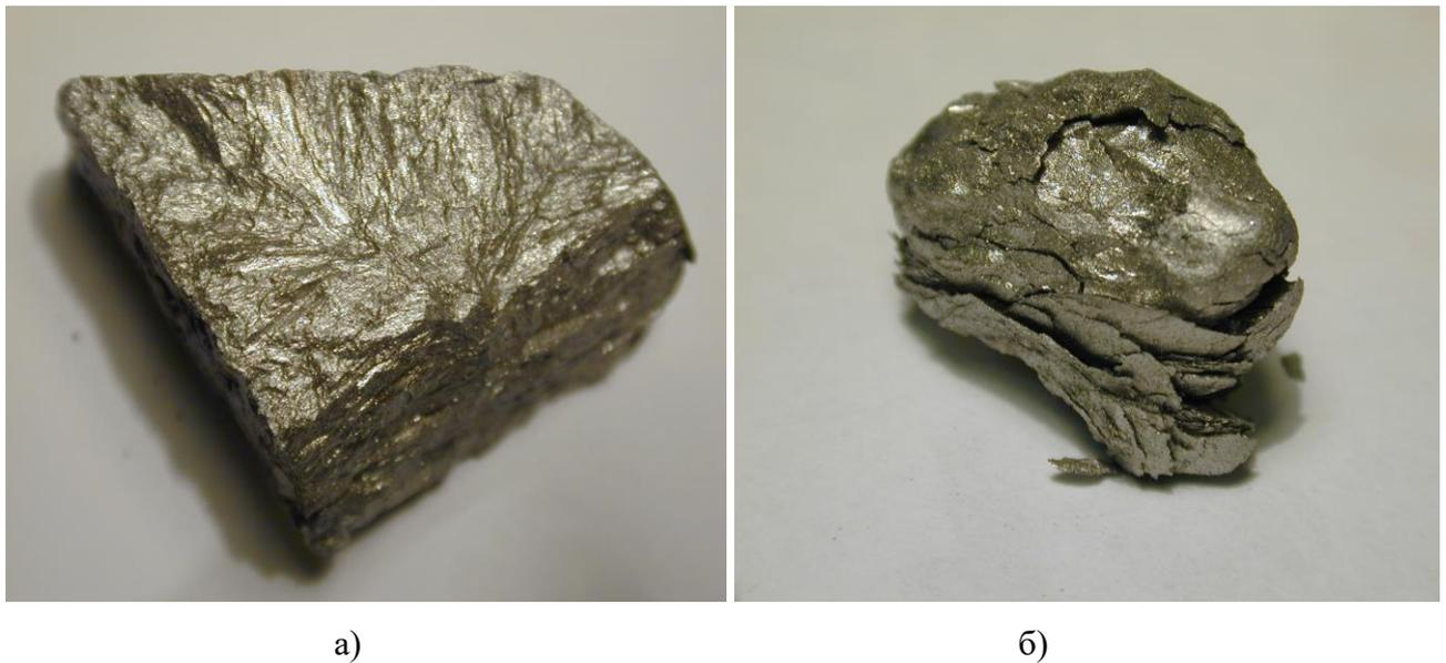
Рисунок 15 - Общий вид образцов сплава Nd-Fe-B (а) в литом состоянии и (б) после гидрирования (масштаб 2:1)
