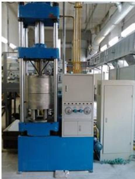
Рисунок 36 – Пресс с магнитными катушками
