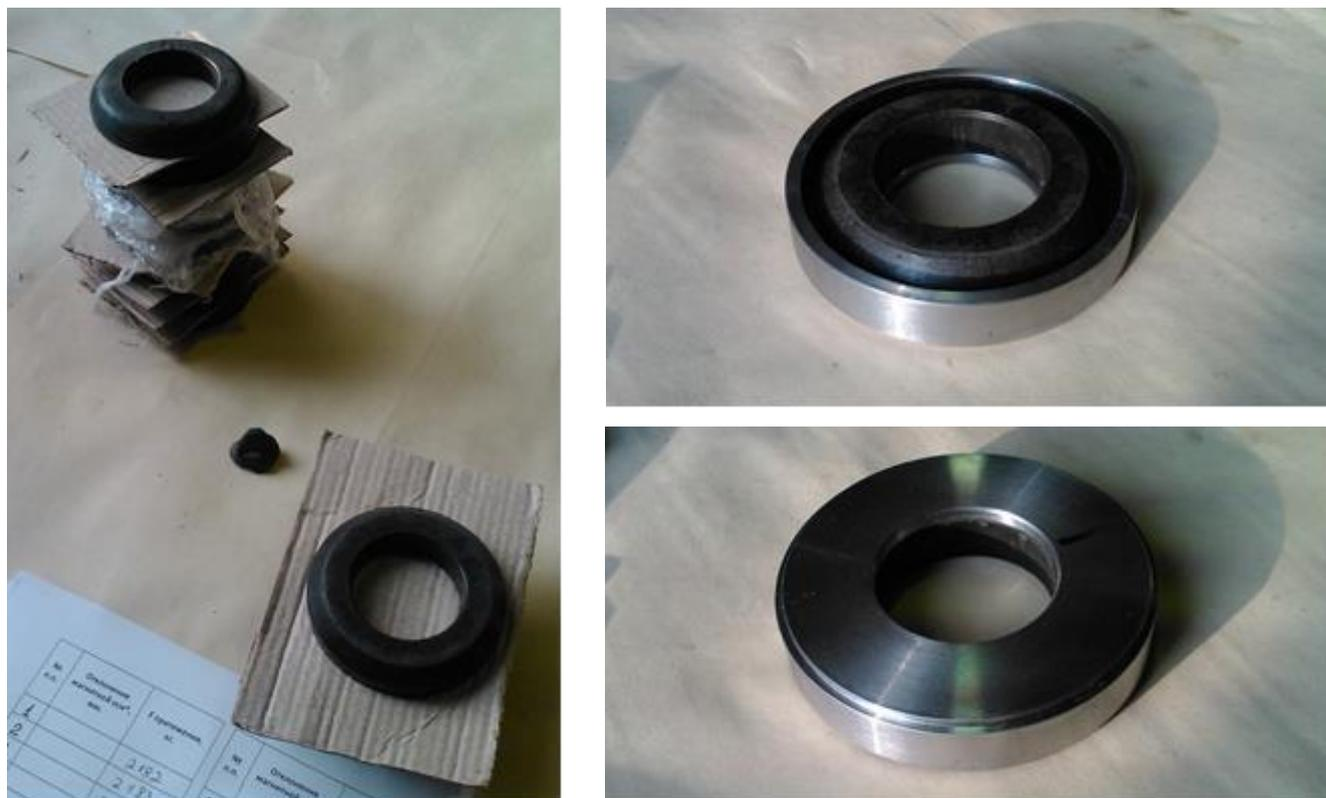
Рисунок 40 – Магниты и магнитные сборки для ВМО.
