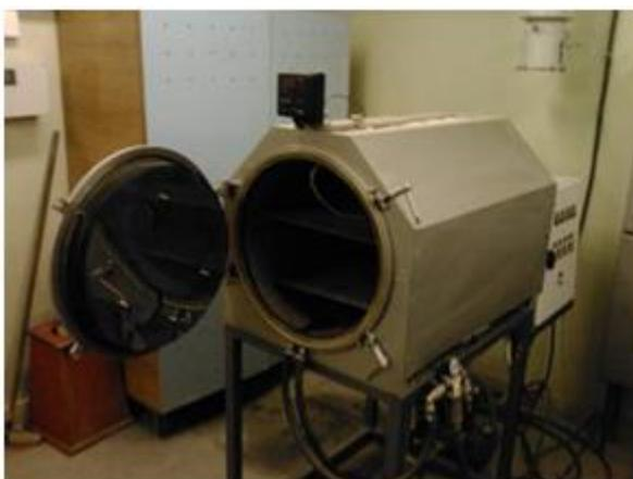
Рисунок 37 – Печь для термообработки
