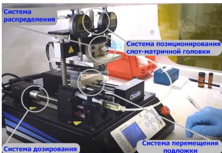
Рисунок 2 – Структура слот-матричного принтера
