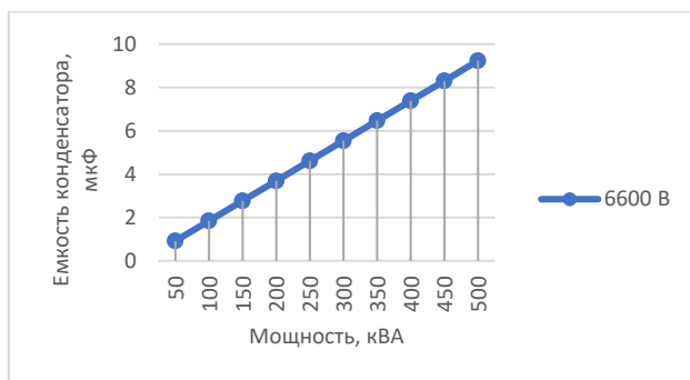
Рисунок 5 - Параметры накопительной емкости активного фильтра высших гармоник
