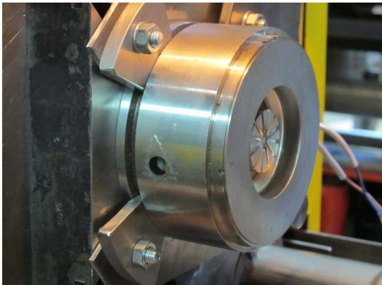
Рисунок 10 – Комбинированная прессформа для литья магнитопластов
