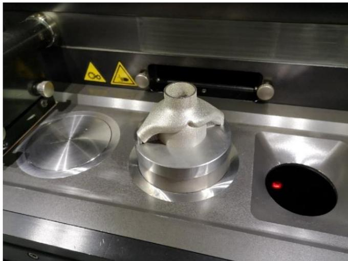
Рисунок 80 – Деталь типа «эжектор» полученная методом СЛС из сплава АЖК
