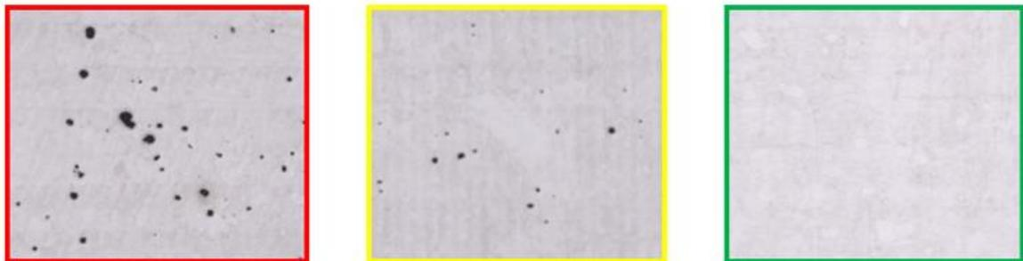
Рисунок 26 – Дефекты, зафиксированные в структуре образцов из сплава АЖК при проведении параметрических исследований процесса СЛС
