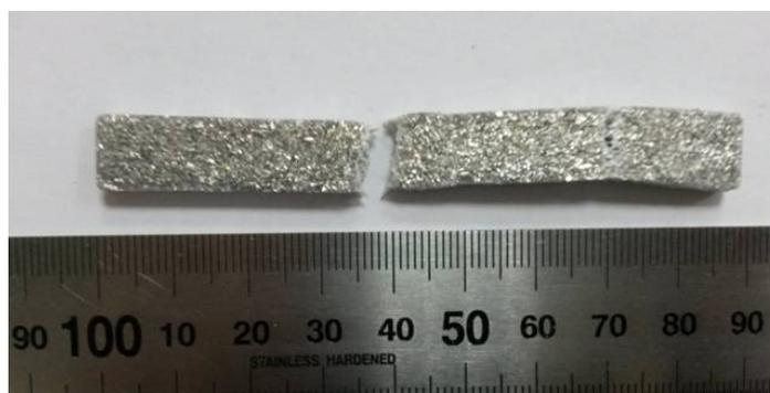
Рисунок 59 – Образец на основе ПЭ + 10 % масс. Аморфной ленты ( $Mg_{67,5}Ca_5Zn_{27,5}$ )
