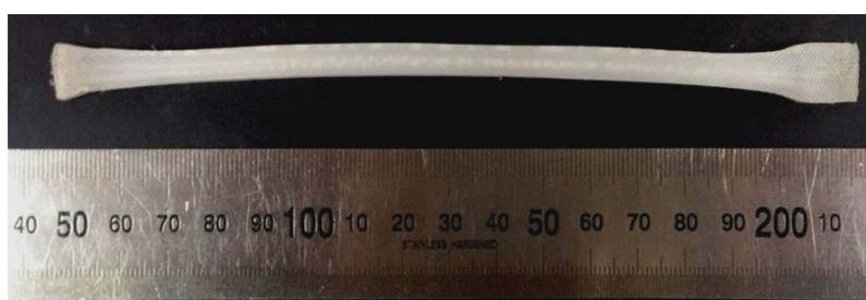
Рисунок 62 – Образец, полученный прессованием, на основе СВМПЭ с тремя аморфными лентами ( $Al_{85}Ni_5Y_8Co_2$ ) вытянутых вдоль образца
