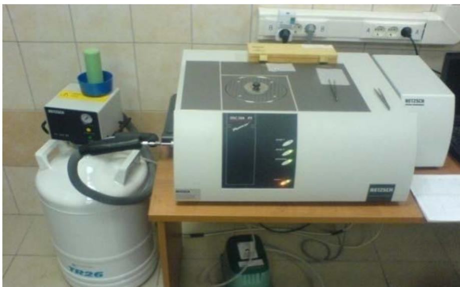
Рисунок 23 – дифференциальный сканирующий калориметр (ДСК) NETZSCH DSC 204 F1 Phoenix
