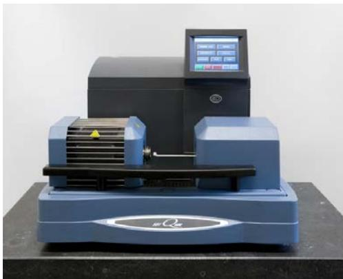
Рисунок 24 – Синхронный термоанализатор ТГ/ДСК/ДТА SDT Q600
