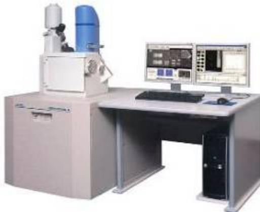
Рисунок 25 – Установка СЭМ JSM 6610 высокого разрешения фирмы JEOL
