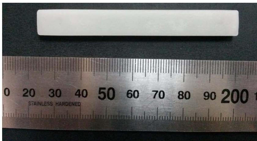
Рисунок 49 – Полученный образец чистого полиэтилена высокой плотности
