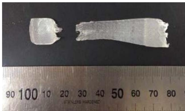
Рисунок 56– Образец на основе чистого полиэтилена
