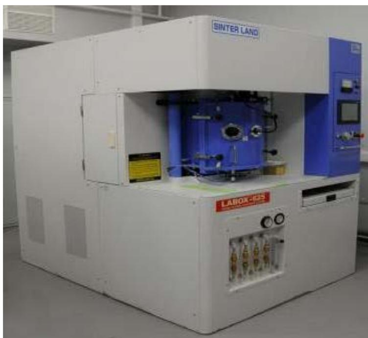
Рисунок 31 – Система спекания в плазме искрового разряда (SPS)
