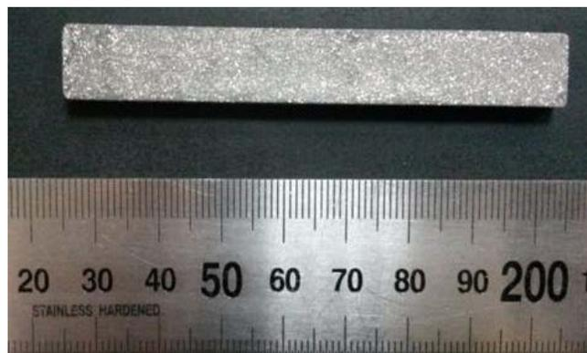
Рисунок 64 – Образец на основе ПЭ + 10 % масс. Аморфной ленты ( $Mg_{67,5}Ca_5Zn_{27,5}$ )
