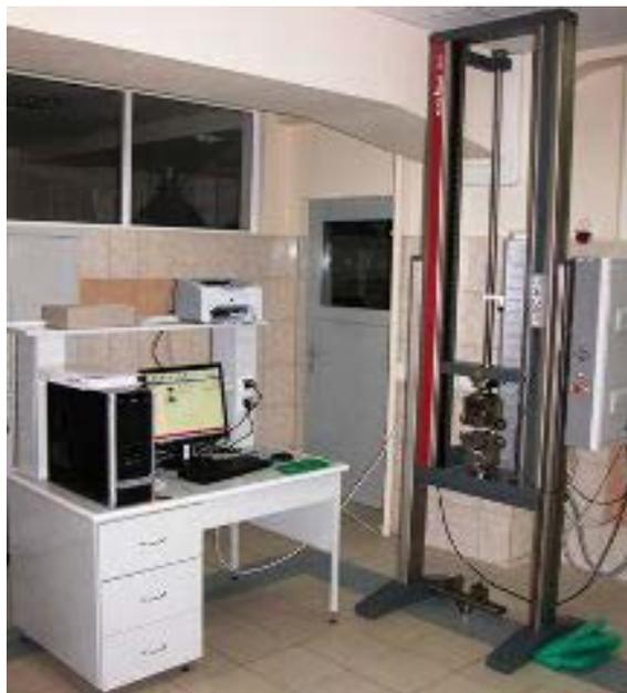
Рисунок 26 – Универсальная испытательная машина ZWICK/ROELL Z020
