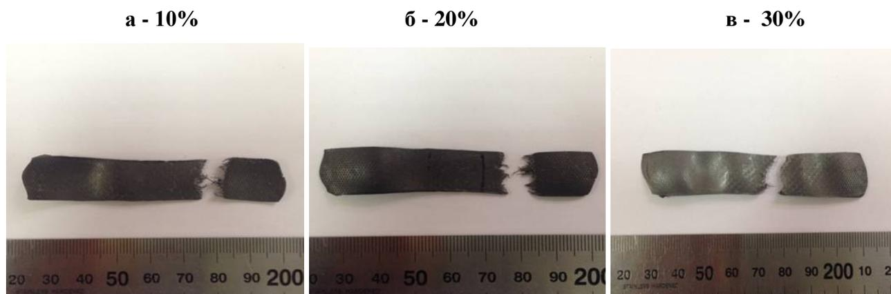
Рисунок 57 – Ориентированные образцы на основе ПЭ с различной концентрацией аморфной ленты ( $Al_{85}Ni_5Y_8Co_2$ ): 10 % масс. (а), 20 % масс. (б), 30 % масс. (в)
