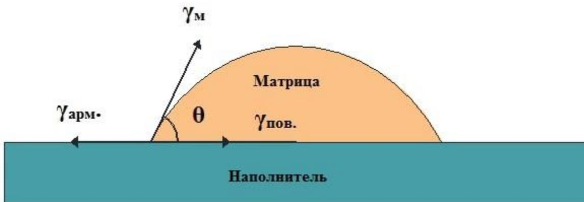
Рисунок 1.8 - Контактный угол и поверхностная энергия [36]
