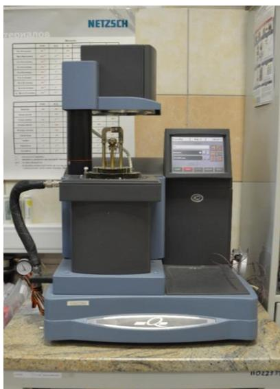
Рисунок 2.9- Динамический механический анализатор ДМАQ800
