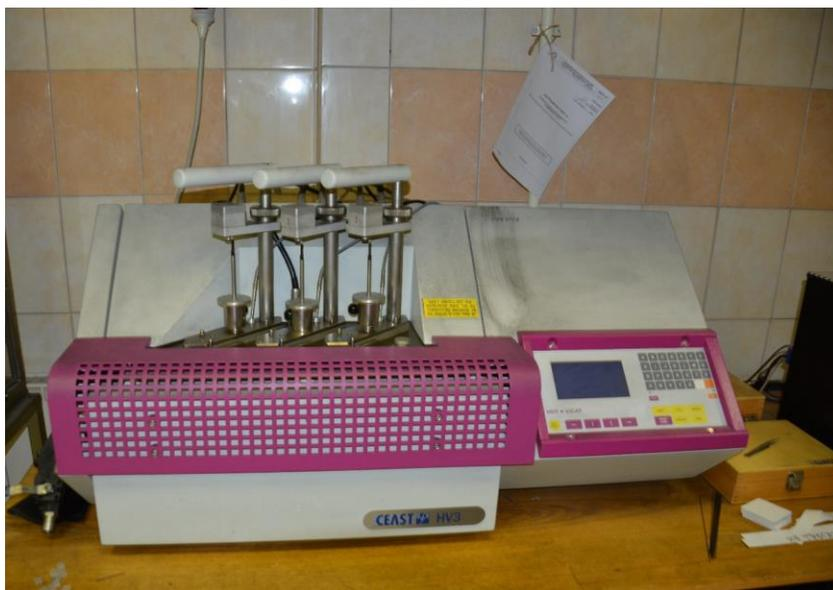
Рисунок 2.10- Прибор Инстрон CEAST 6910 HDT/Vicat
